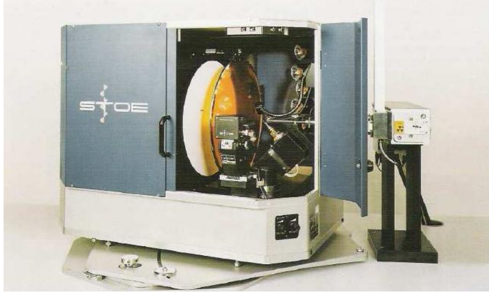
Şekil 2.14 STOE IPDS II Kırınım metresinin dış görünümü
