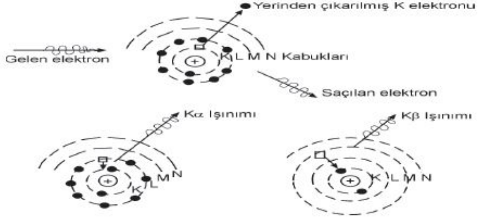
Şekil 1.24 Karakteristik X-ışını spektrumu oluşumu
