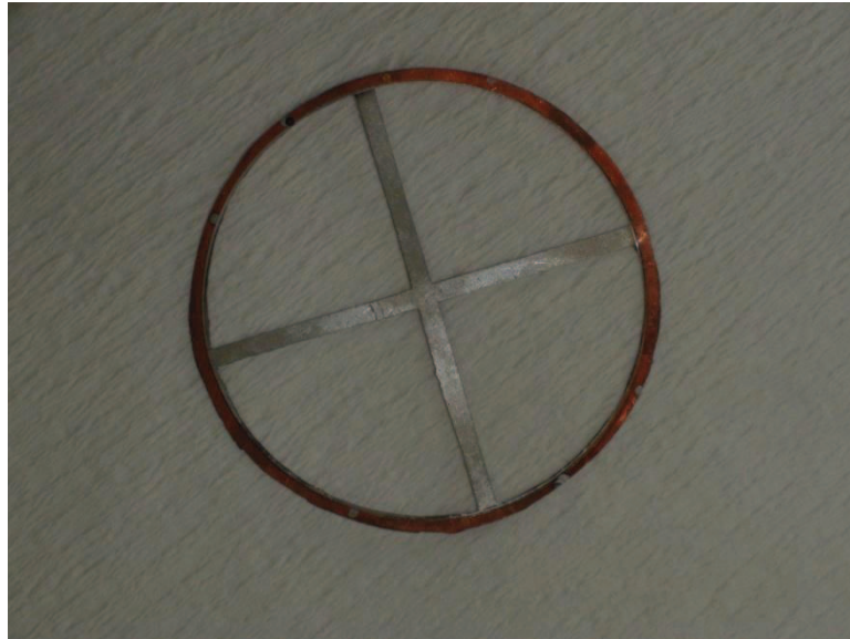
Şekil 3.6 Omik kontakın oluşturulması için kullanılan metal maske.
