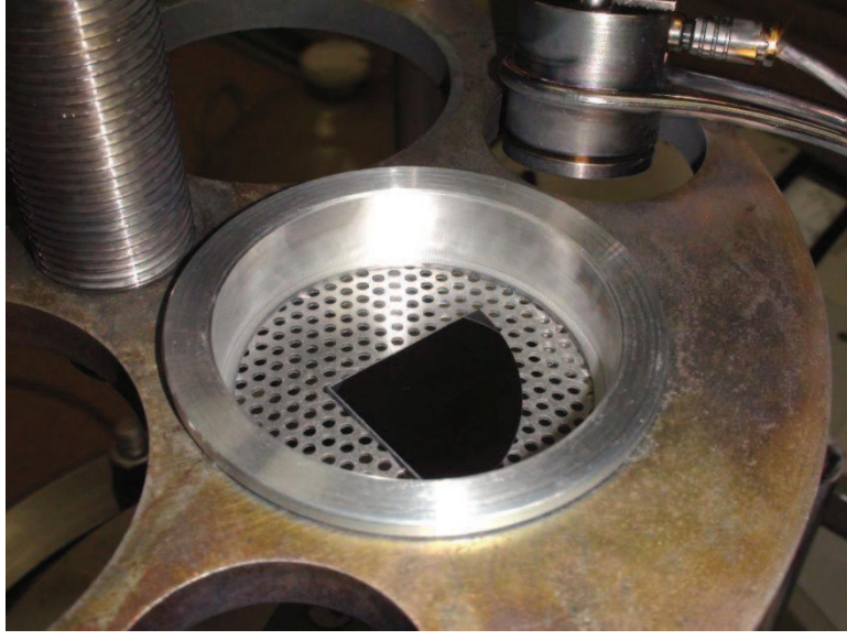
Şekil 3.7 Numune tutucu içerisine maske ile yerleştirilmiş silisyum kristali.
