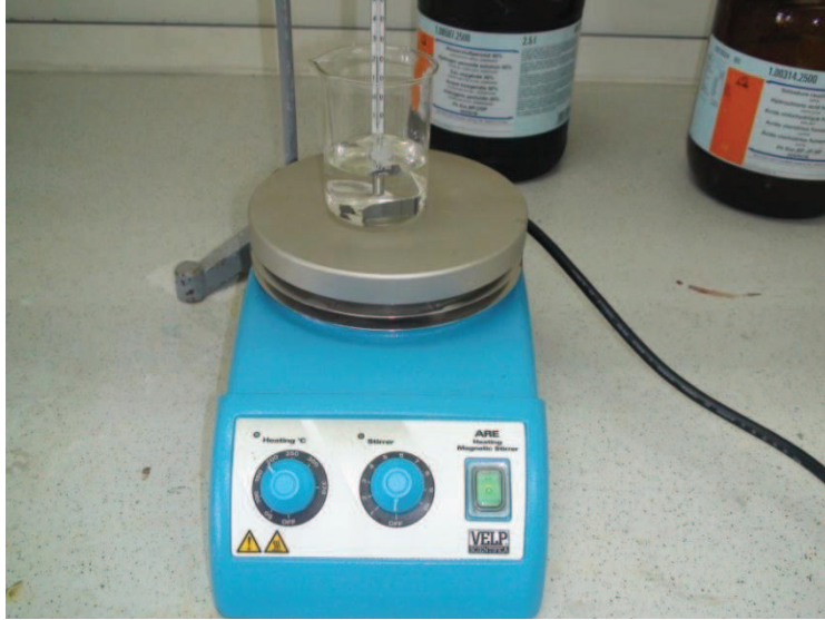
Şekil 3.4 Kristal temizliği aşamasında kullanılan ısıtıcı düzeneği.
