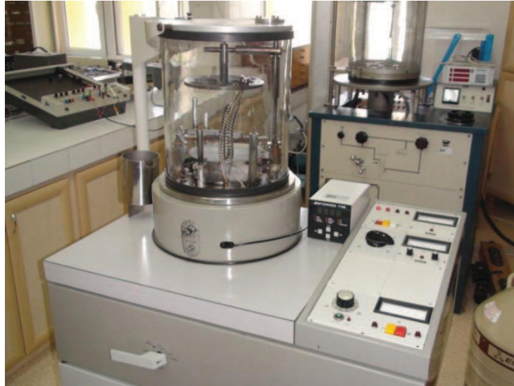
Şekil 3.5 Al/p-Si yapılarının oluşturulması sırasında kullanılan “Edwards” marka evaporasyon sistemi.
