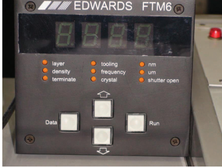
Şekil 3.9 “Edwards FTM6” marka kalınlık ölçer.
