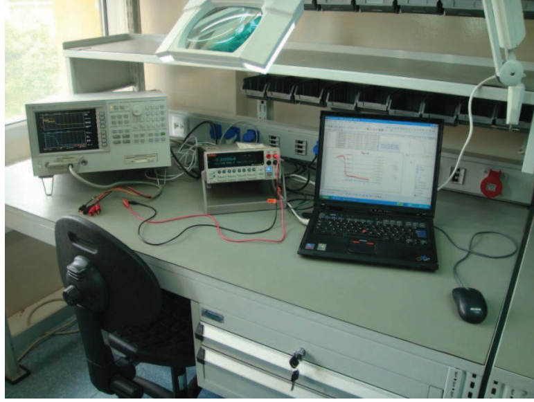
Şekil 3.14 Bilgisayar kontrollü Keithley 2400 Source Meter ve Agilent 4294A Precision Impedance Analyzer cihazları.
