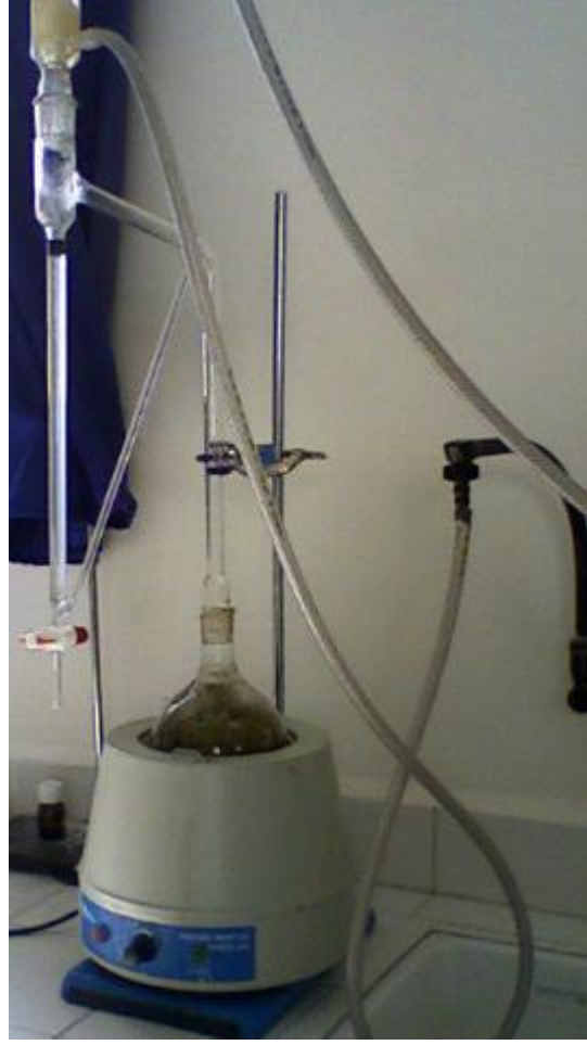
Şekil 2.2 Clevenger tipi su buharı destilasyon düzeneği
