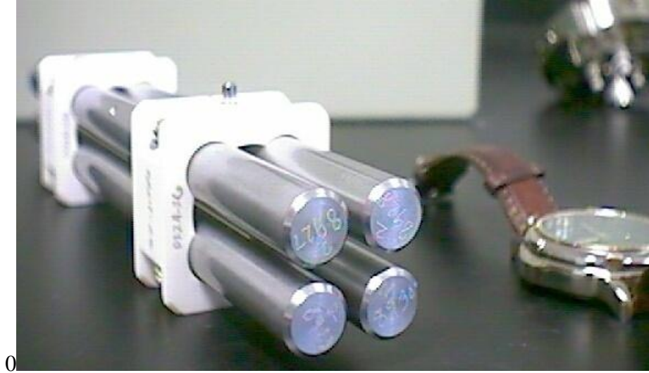
Şekil 1.26 Temizleme için MS spektrometresinden çıkan bir quadropole
