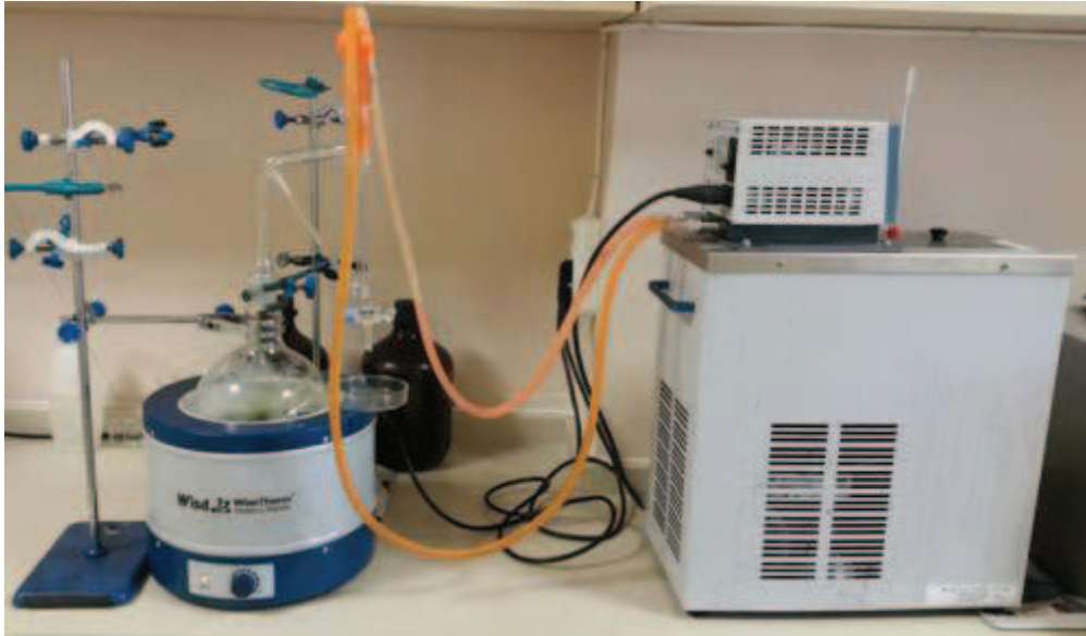
Şekil 2.2: Clevenger su buharı destilasyon düzeneği
