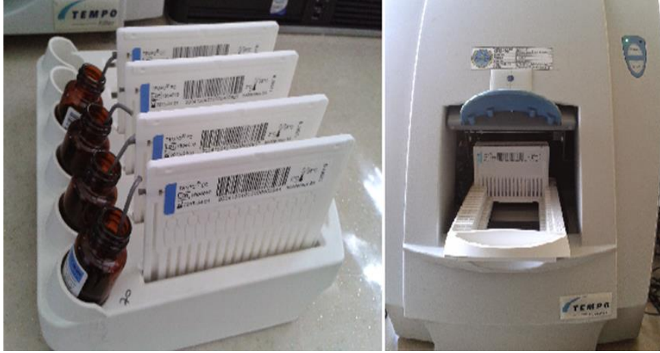
Şekil 2.4 Mikrobiyal test kitleri ve Tempo reader cihazı
