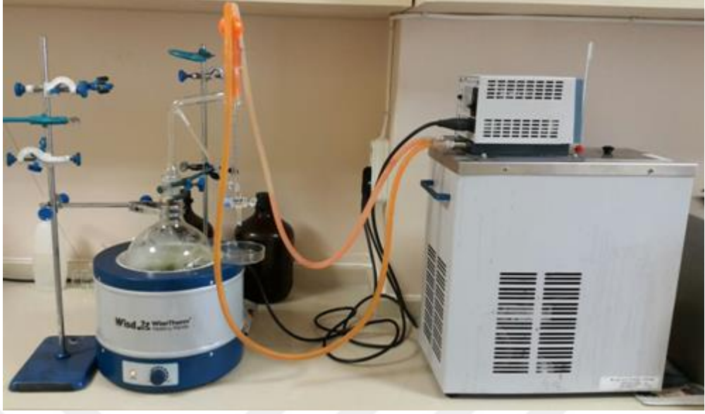
Şekil 2.2. Clevenger su buharı destilasyon düzeneği
