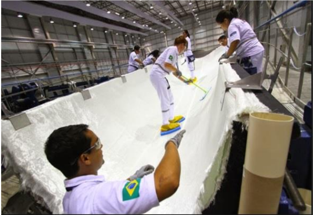
Şekil 2.18 Cam kumaşların kalıba serilmesi [55]
