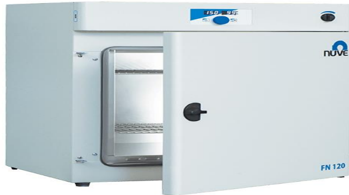
Şekil 4.15 Su absorpsiyon deneyi için kullanılan sıcak ortam sağlayıcısı
