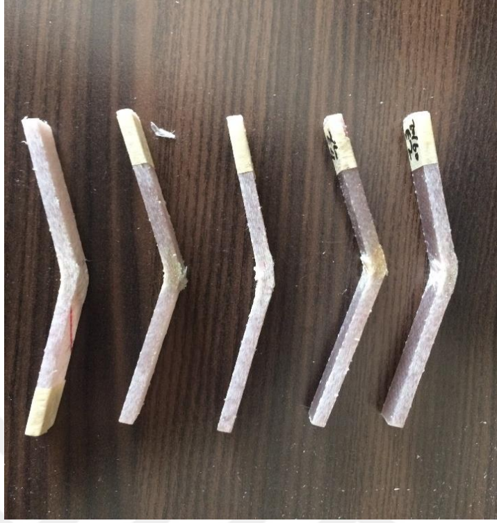
Şekil 5.30 30°/60° oryantasyonlu numunelerin eğilme deneyi sonrası görüntüleri
