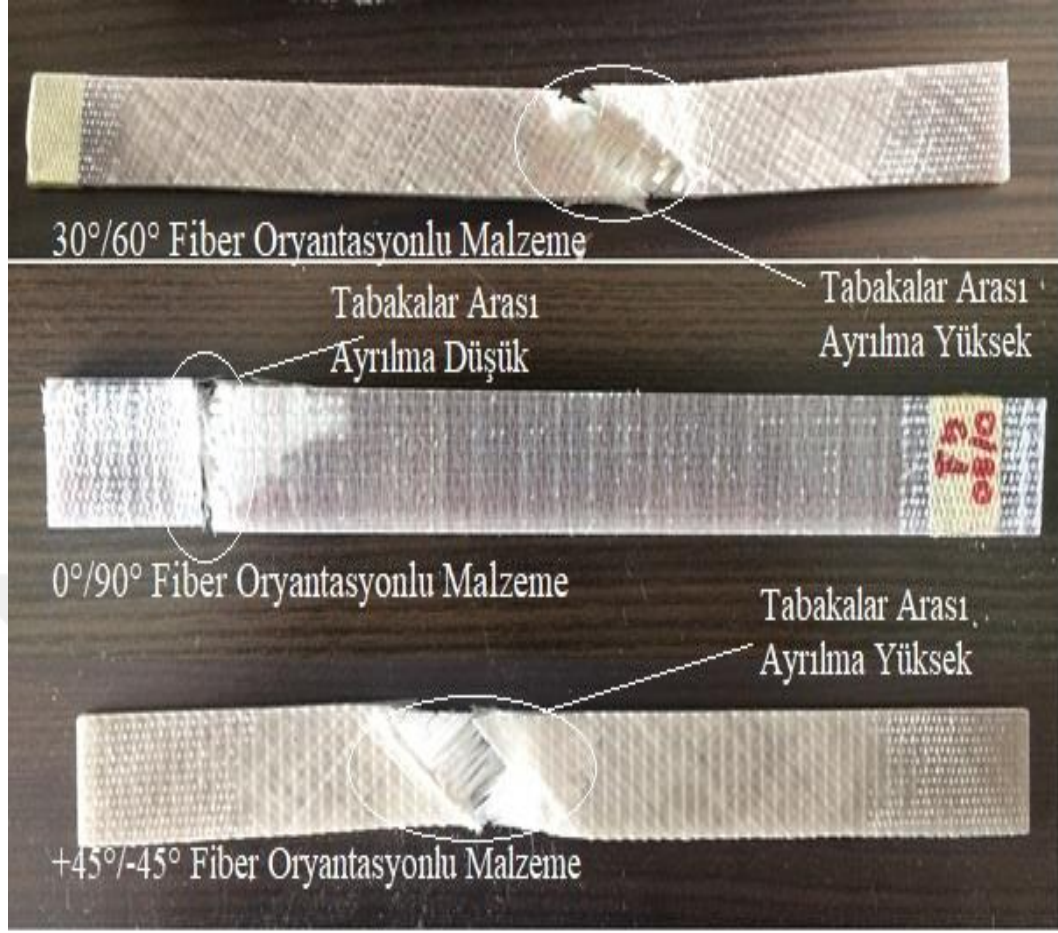
Şekil 5.24 Çekme numunelerinde görülen tabaka ayrılmaları
