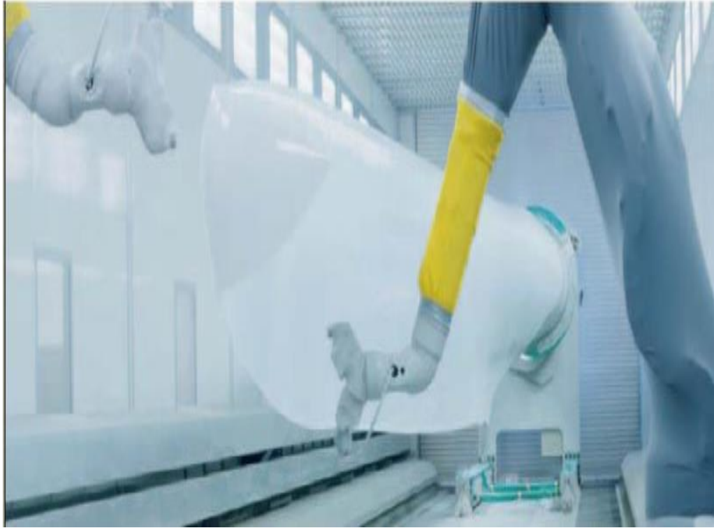
Şekil 2.22 Robot kolları ile yapılan yüzey işlemi [53]
