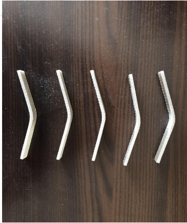
Şekil 5.31 \pm 45^\circ oryantasyonlu numunelerin eğilme deneyi sonrası görüntüleri
