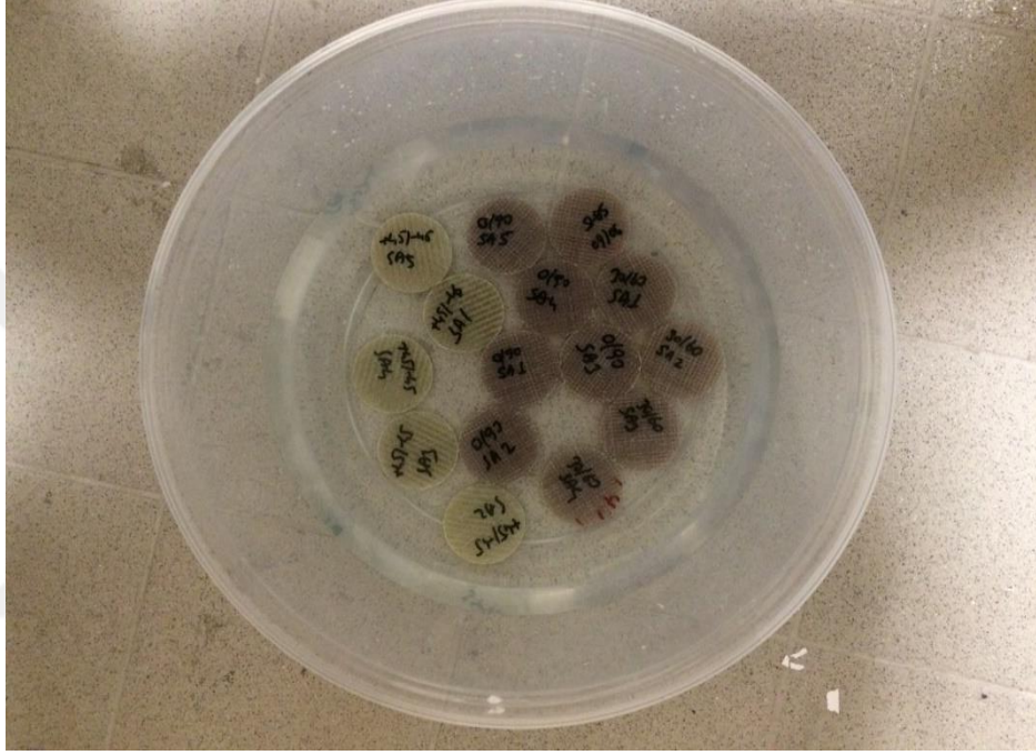
Şekil 4.16 Su absorpsiyon deney düzeneği
