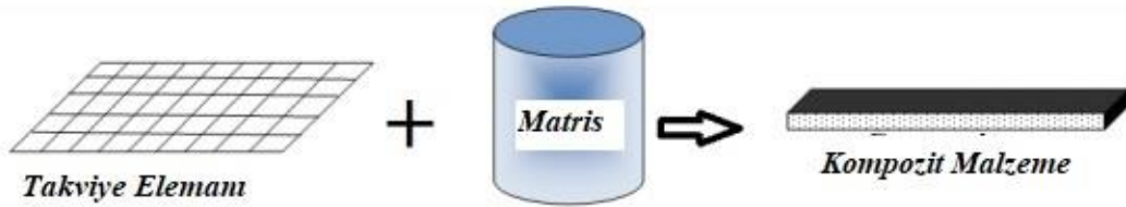
Şekil 3.1 Kompozit malzemenin yapıtaşları [59]
