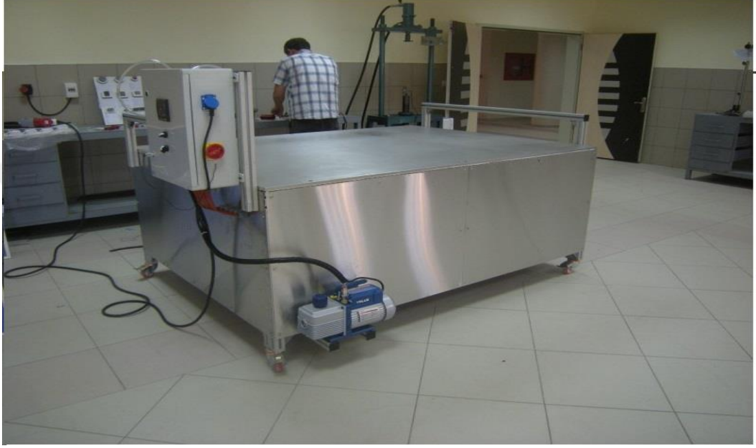
Şekil 4.1 Kompozit plakaların üretiminde kullanılan vakum infüzyon tezgahı
