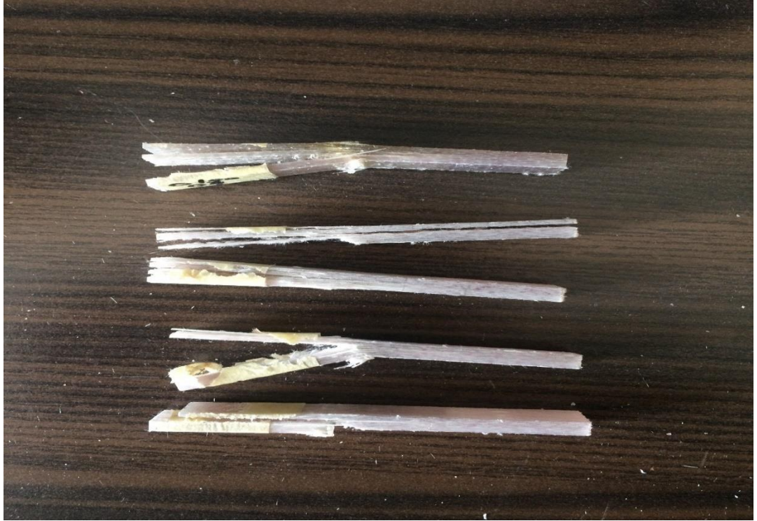
Şekil 5.27 0°/90° elyaf oryantasyonlu numunelerdeki delaminasyonlar
