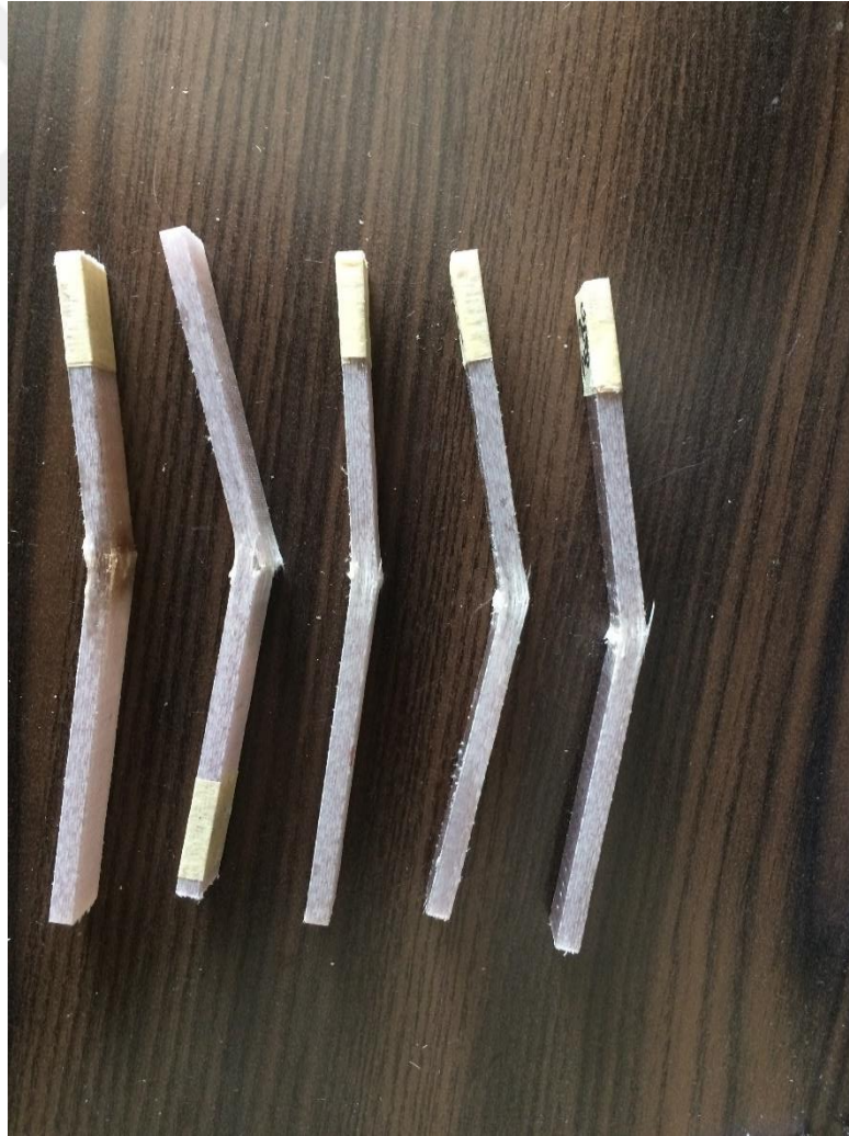
Şekil 5.29 0^{\circ}/90^{\circ} oryantasyonlu numunelerin eğilme deneyi sonrası görüntüleri
