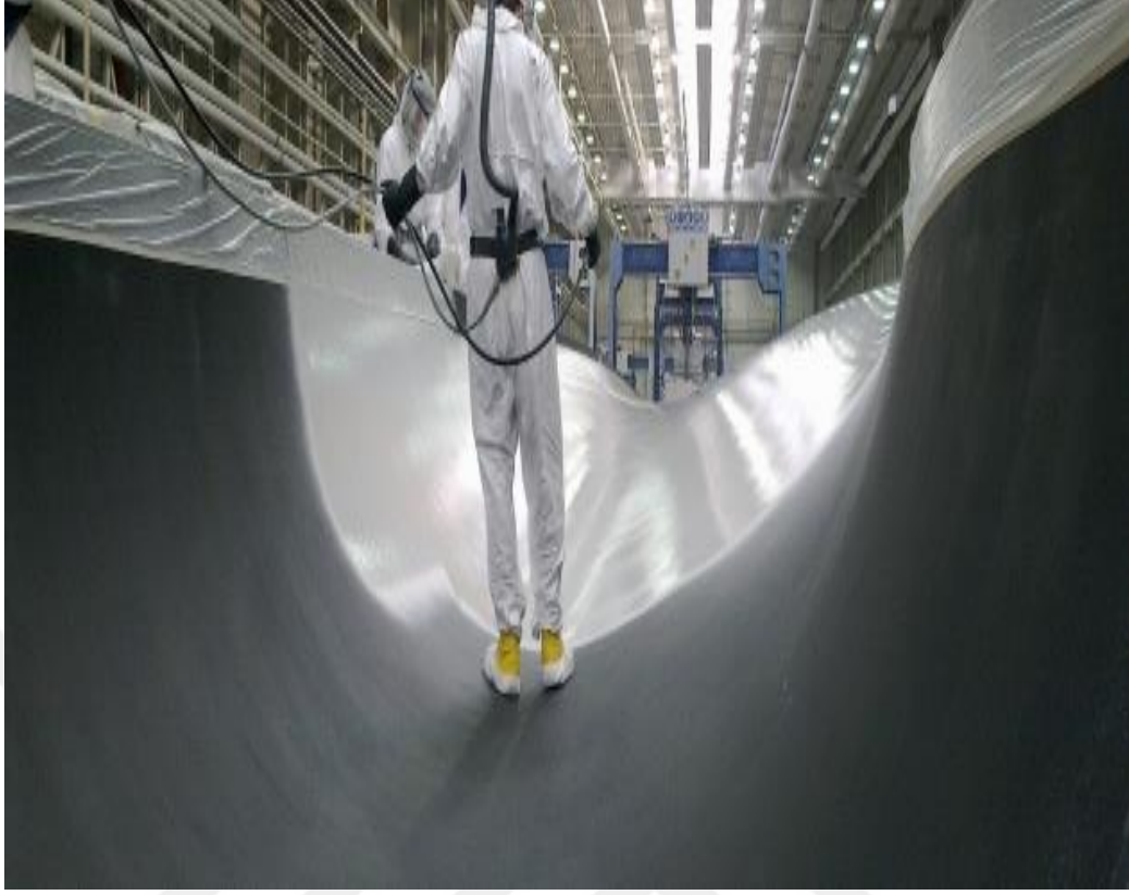
Şekil 2.21 Püskürtme tabancası ile yapılan yüzey işlemi [57]
