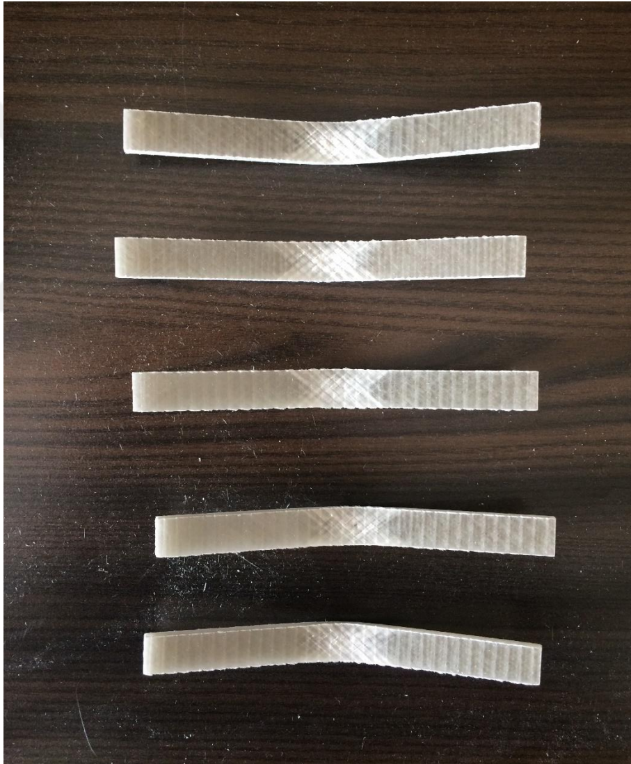
Şekil 5.32 \pm 45^\circ oryantasyonlu numunelerde meydana gelen üst tabaka ayrılması
