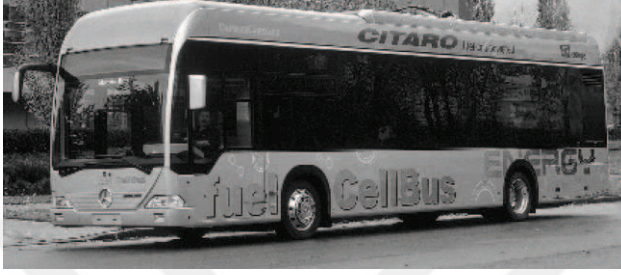
Şekil 2.4. 2003 'de hizmete sunulan yakıt pilli otobüs [1]
