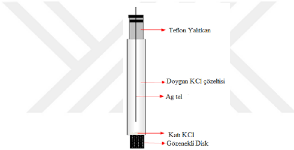
Şekil 2.3. Ag/AgCl Referans Elektrotu[19]
