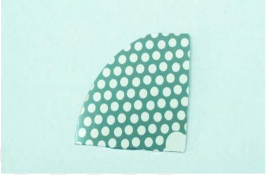
Şekil 3.12 Çeyrek Silisyum alttabaka üzerinde oluşturulan Al/Coronene/ n -Si Schottky yapılarının görüntüsü.
