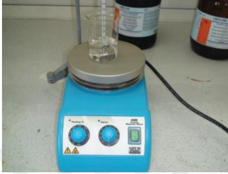
Şekil 3.4 Kristal temizliği aşamasında kullanılan ısıtıcı düzeneği.
