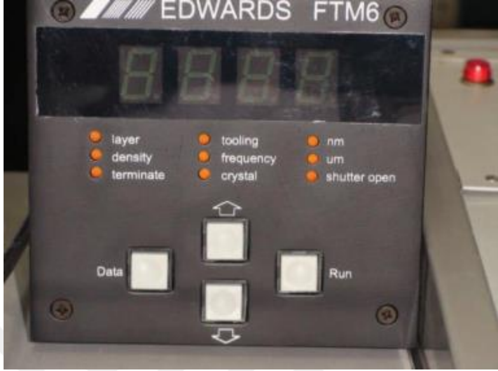
Şekil 3.9 “Edwards FTM6” marka kalınlık ölçer.
