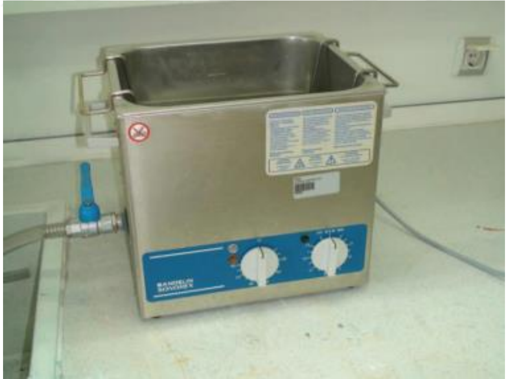
Şekil 3.2 “Bandelin Sonorex” marka ultrasonik banyo.
