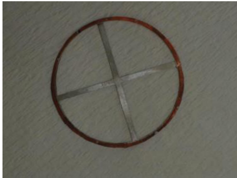
Şekil 3.6 Omik kontakın oluşturulması için kullanılan metal maske.
