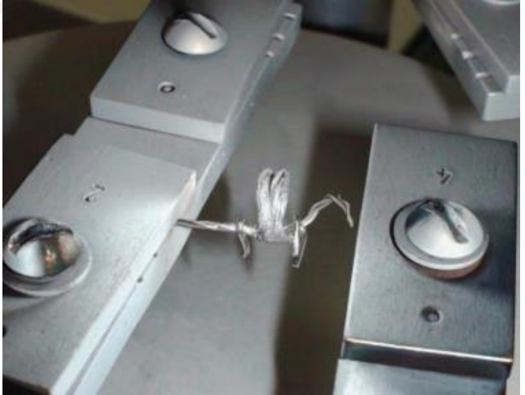
Şekil 3.8 Evaporasyon işleminde kullanılan tungsten pota.
