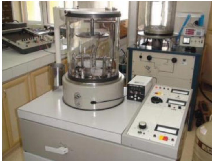
Şekil 3.5 Al/Coronene/n-Si yapılarının oluşturulması sırasında kullanılan “Edwards” marka evaporasyon sistemi.
