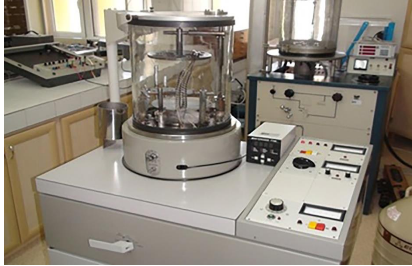
Şekil 3.2. Al/Coronene/ n -Si yapısının oluşturulması sırasında kullanılan “Edwards” marka evaporasyon sistemi [26].
