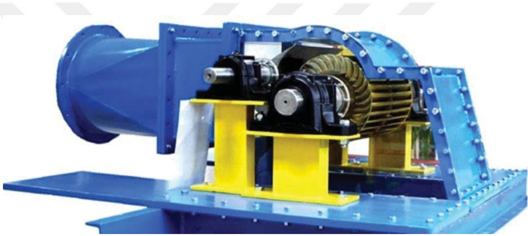
Şekil 2.19. Banki (Crossflow) türbin modeli [41]
