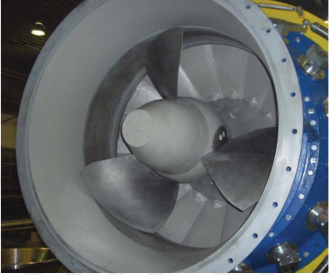
Şekil 2.20. 3 adet kanata sahip kaplan türbin [43]
