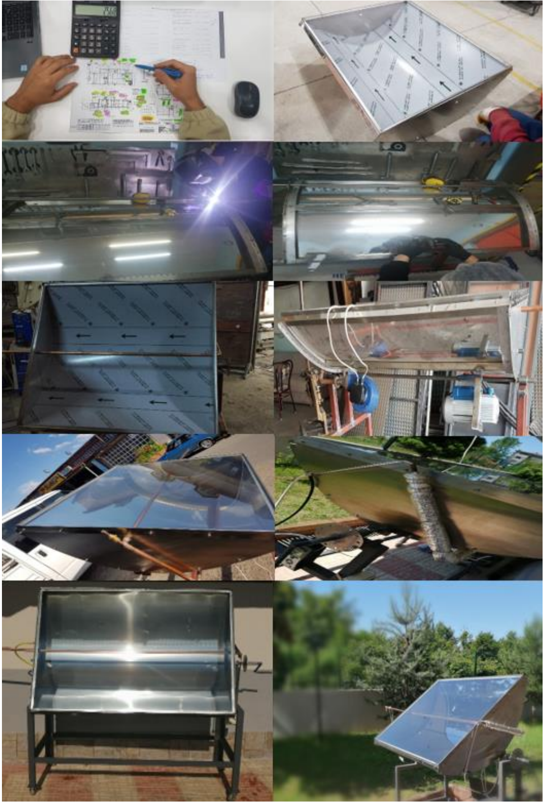
Şekil 6. 11.Konstrüksiyon imalat süreci.
