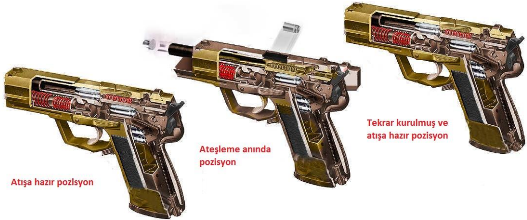
Şekil 1.1. Yarı otomatik bir tabancanın çalışma pozisyonları [1]
