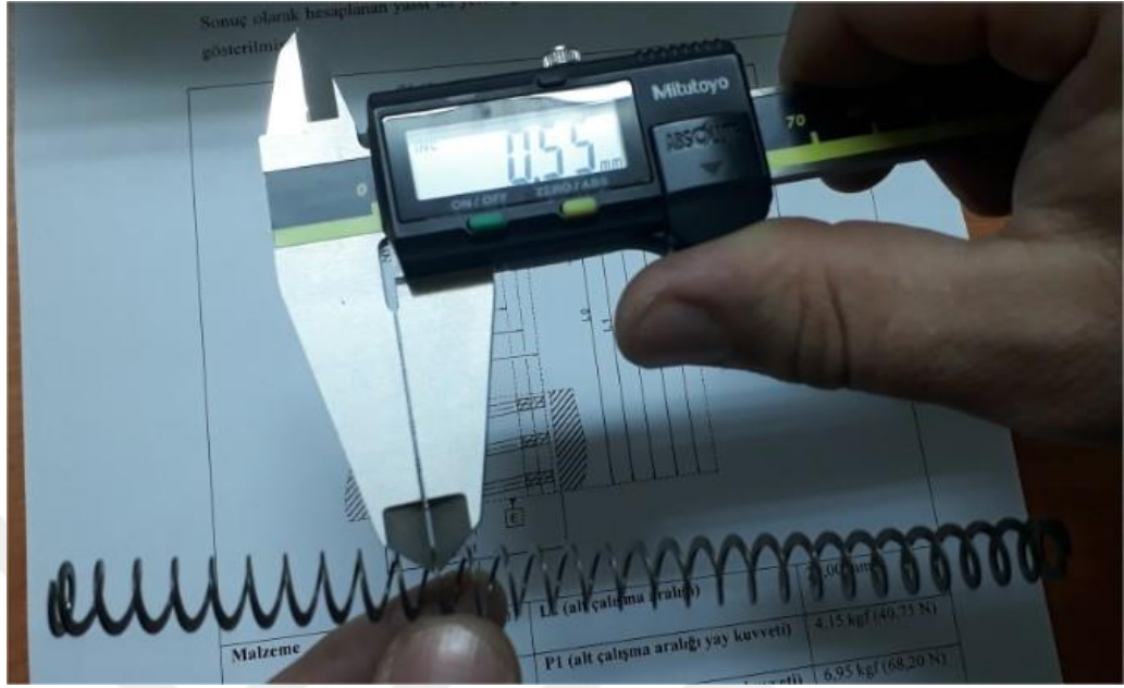
Şekil 3.25. Numune yassı tel yerine getiren yay tel kesit yüksekliđi (h) değeri
