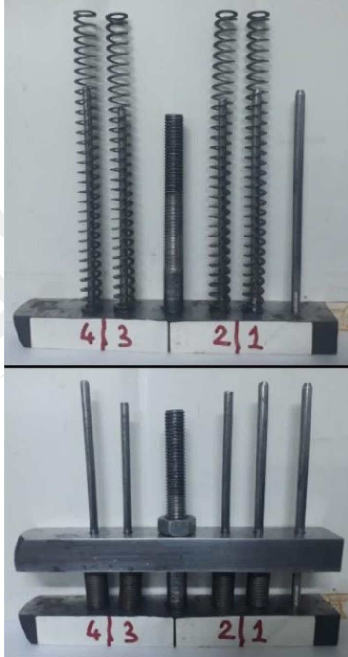
Şekil 3.36. Yassı tel yaylara baskıya alma testinin uygulanması
