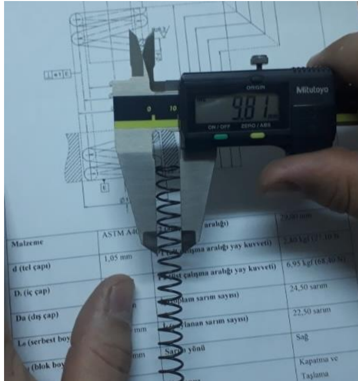
Şekil 3.18. Numune yuvarlak tel yerine getiren yay dış çap ( D_a ) değeri
