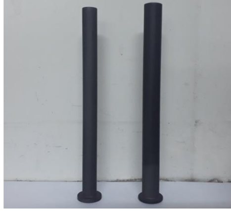
Şekil 3.41. Yorulma testi için üretilen yuvarlak ve yassı tel yerine getiren yay milleri
