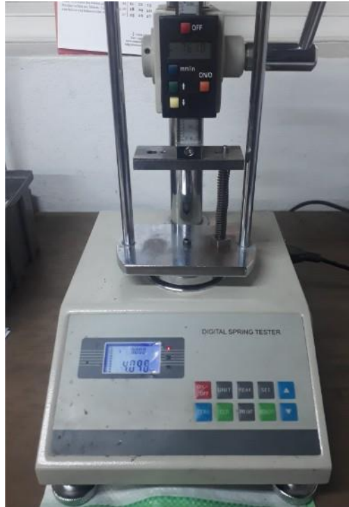
Şekil 3.30. Numune yassı tel yerine getiren yay üst çalışma aralığı ( P_1 ) değeri
