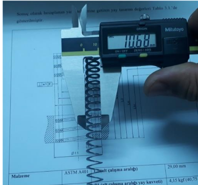
Şekil 3.28. Numune yassı tel yerine getiren yay dış çap ( D_a ) değeri
