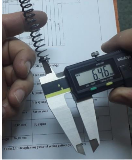
Şekil 3.27. Numune yassı tel yerine getiren yay iç çap ( D_i ) değeri
