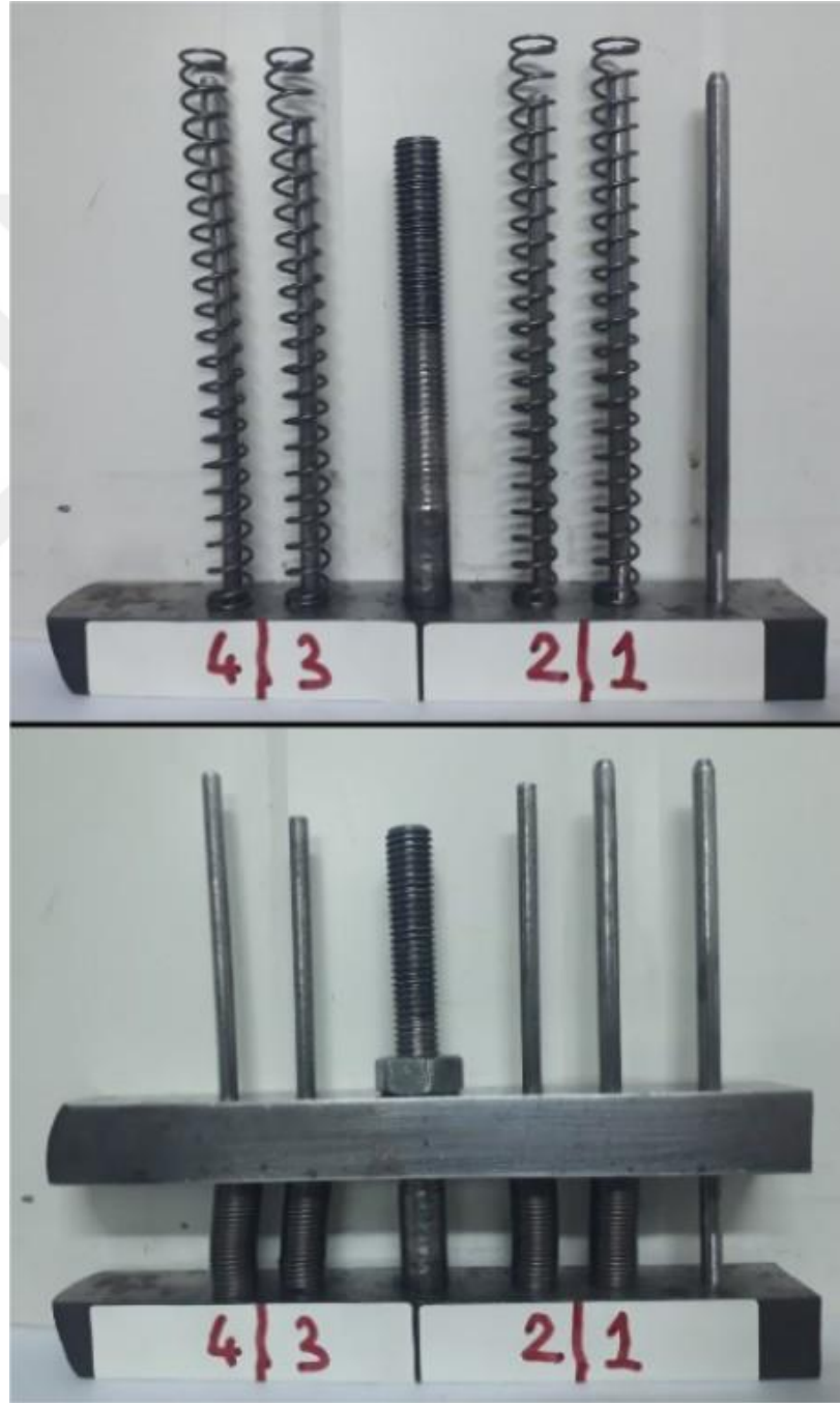
Şekil 3.35. Yuvarlak tel yaylara baskıya alma testinin uygulanması
