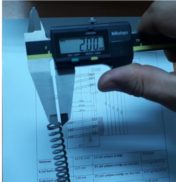
Şekil 3.26. Numune yassı tel yerine getiren yay tel kesit genişliđi (b) değeri
