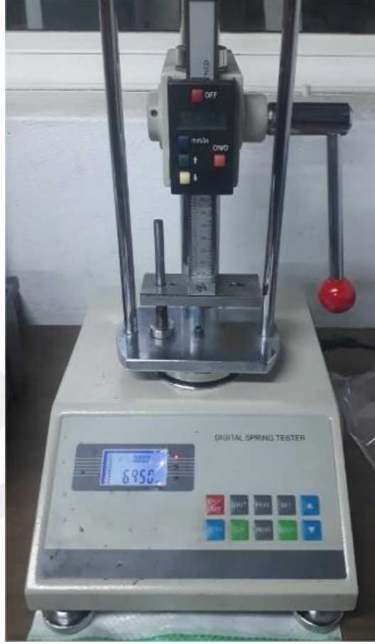
Şekil 3.21. Numune yuvarlak tel yerine getiren yay alt çalışma aralığı ( P_2 ) değeri
