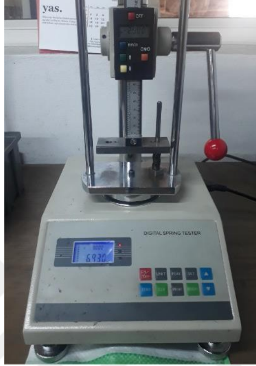
Şekil 3.31. Numune yassı tel yerine getiren yay alt çalışma aralığı ( P_2 ) değeri
