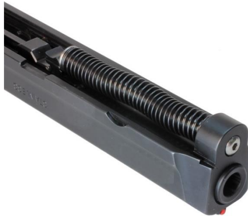
Şekil 3.3. Yerine getiren yayın tabanca kapak parçası üzerinde montaj hali [5]
