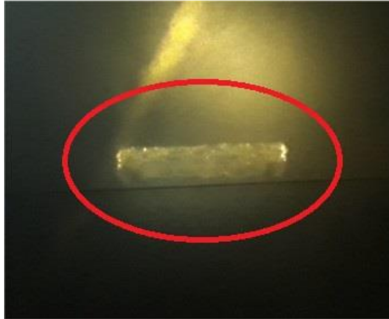
Şekil 3.24. Numune yassı tel yerine getiren yay büyütülmüş tel kesit görüntüsü
