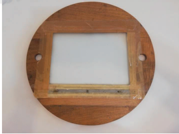
Resim 14. Çizim Masası (Hareketli) Kapağı ve Standart Asetat Pimi
