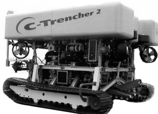
Figure 1.10: CTC Marine C-Trencher 2, exemple de ROV de class Défoncement/enterrement [10]
