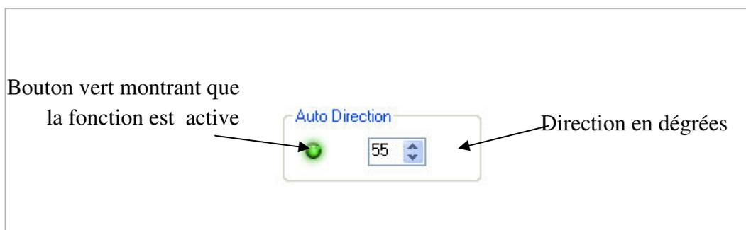
Figure 3.23: La fonction auto-direction fixé a 55 degré
