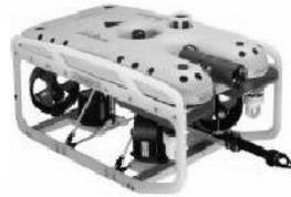
Figure 1.7: SeaEye Falcon, exemple de ROV de classe générale [8]
