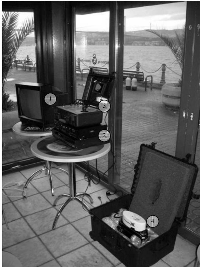
(1 – Télévision, 2 – Equipement d'enregistrement, 3 – Unité de contrôle de VideoRay, 4 – VideoRay)
