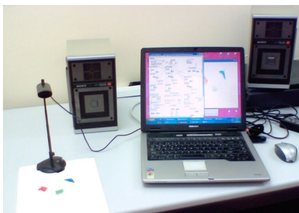
Figure 2.14: Configuration du système, webcam pour l'entrée visuelle, fond blanc, des objets colorés, PureData pour la création de la rétroaction auditive.
