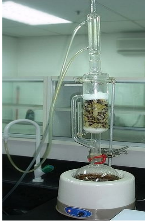
Resim 7: Sokslet ekstraksiyon sistemi
