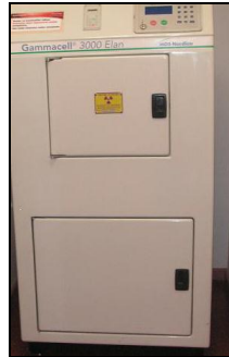
Şekil19.Işınlama Cihazı ve Işınlanmış Havuz Trombosit Süspansiyonu
