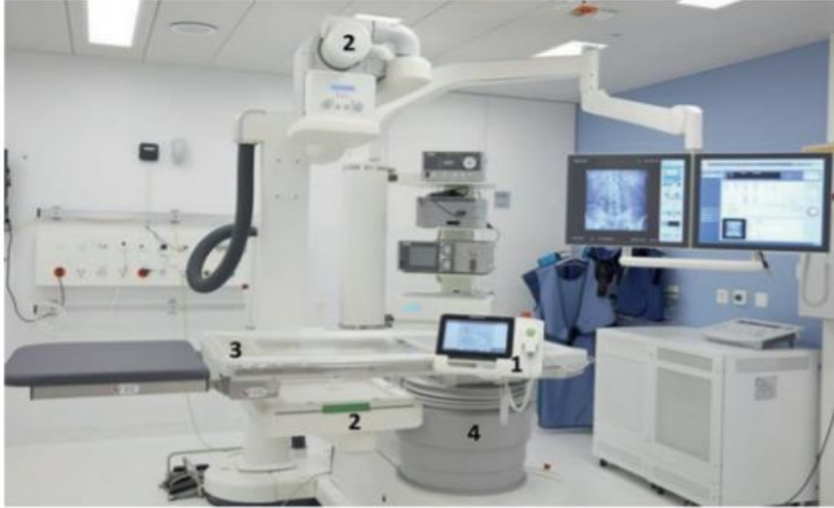
Resim 2.1: ESWL cihazı, (1) işlem ünitesi, (2) X-ray, (3) muayene masası, (4) şok dalgası oluşturucu 61 .
