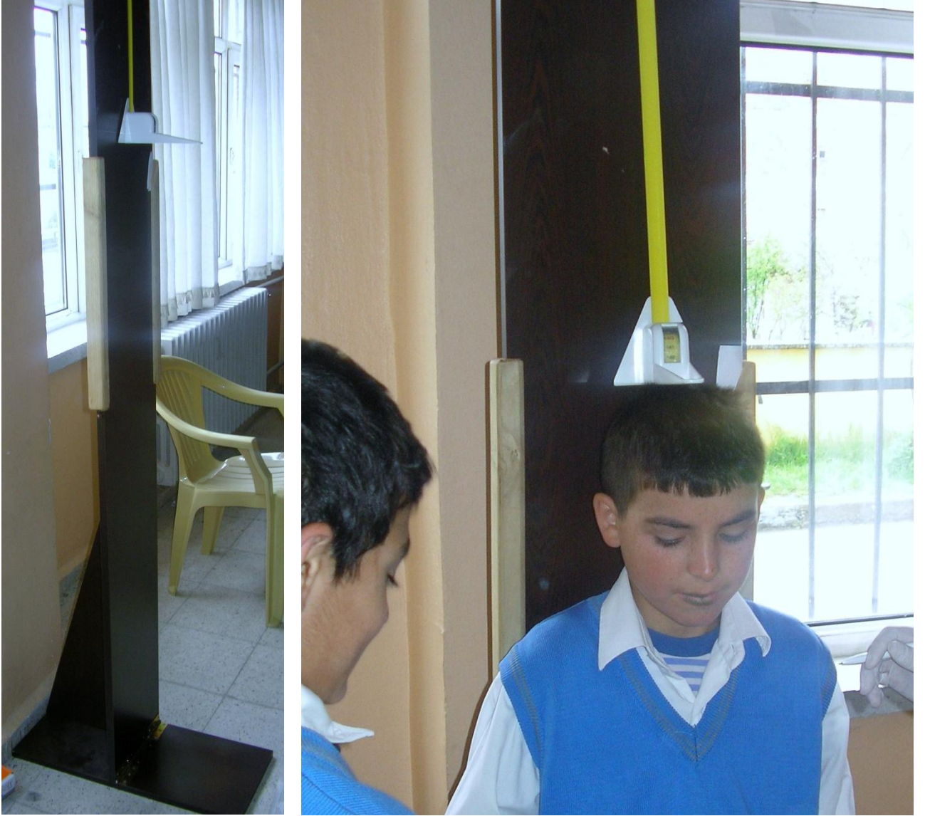
Şekil 3-1 ve Şekil 3-2: Katlanabilir düz bir tahtaya tespit edilmiş medizintechnk Kawe stadiometre cihazı
