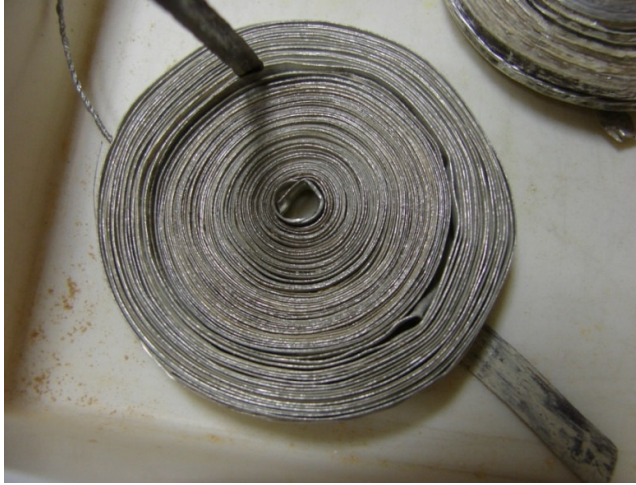
Şekil 3.24 : İçte 4. örnek süperiletken rulo şeklinde sarılmış (primer), dışta 2. örnek şerit sekonder bobin olarak rulo şeklinde sarılmış.
