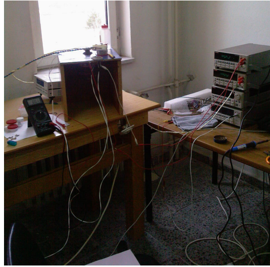
Şekil 4.12 : Süperiletken transformatör deney düzeneği
