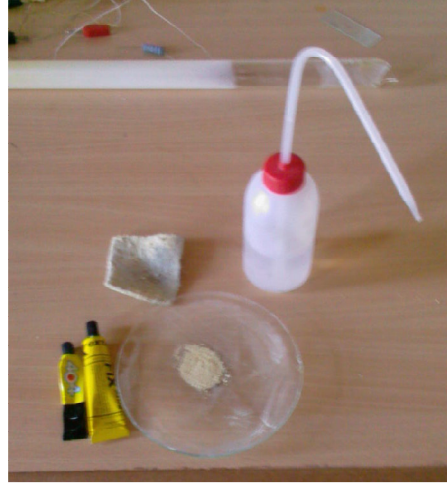
Şekil 3.19 : Süperiletken şerit yalıtımında kullanılan malzemeler
