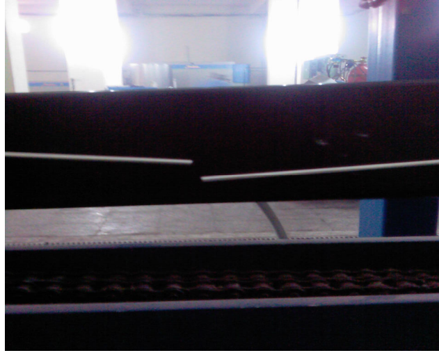
Şekil 3.16 : Tel çekme işlemi esnasında meydana gelen kopma
