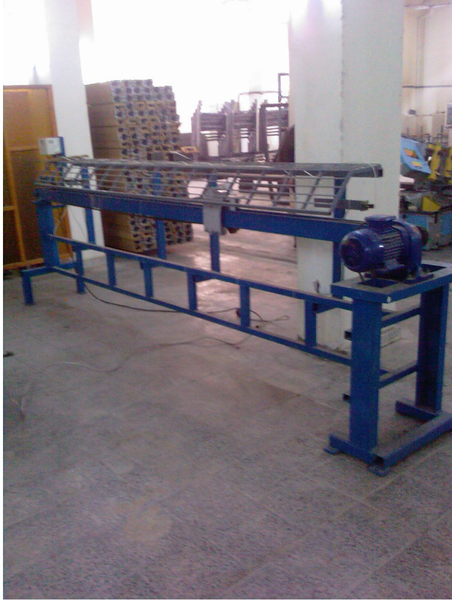
Şekil 3.15 : Değişik devir oranlarında çalışabilen üç metrelik tel çekme cihazı
