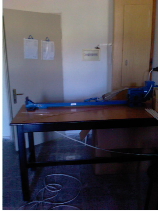
Şekil 3.8 : Bir metreye kadar tel çekebilen tel çekme cihazı
