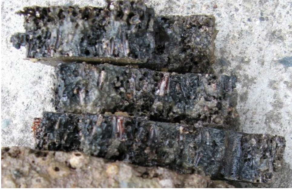
Şekil 4.1: Delici organizmaların saldırısının yoğun olduğu Trabzon limanından çıkarılan odun numunelerine ait bir fotoğraf
