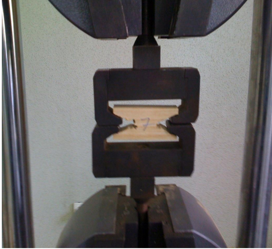
Şekil 12. Liflere Dik Çekme Örneği ve Test Yapımı.
