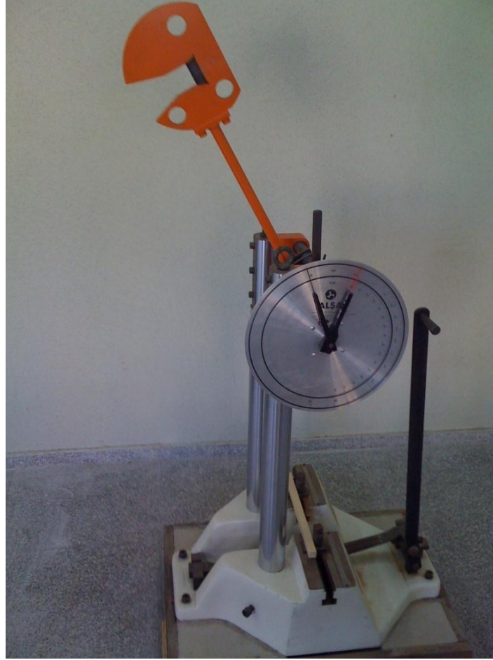
Şekil 9. Pandüllü Çekiç ve Deney Yapımının Şekli.
