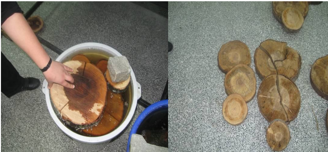
Şekil 8. Örnek silindirlere diri-odun öz-odun kısımlarının belirlenmesi (Orijinal, 2010).
