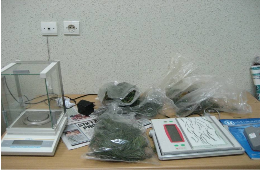
Şekil 6. Alan ölçer ve hassa terazi ile ibre alanlarının ve ağırlıklarının belirlenmesi (Orijinal, 2010)
