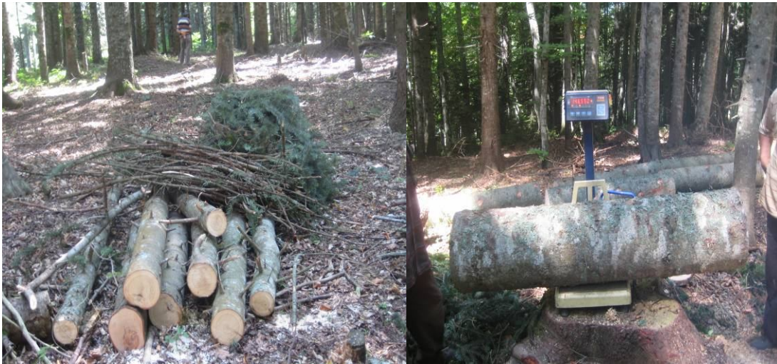
Şekil 5. Dal, yaprak ve gövde olarak ayrılan örnek ağaçların seksiyonlara yarılan gövdelerinin yaş ağırlıklarının arazide belirlenmesi (Orijinal, 2010).
