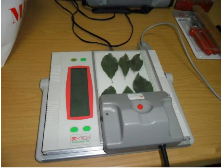
Şekil 6. Alan ölçer ve hassa terazi ile yaprak alanlarının ve ağırlıklarının belirlenmesi (Orijinal, 2010).
