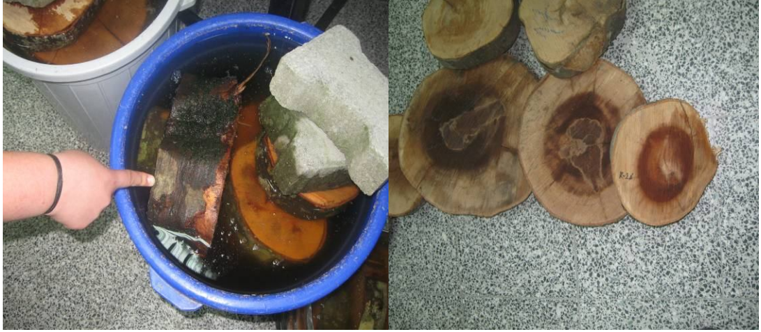
Şekil 8. Örnek silindirlerden diri-odun öz-odun kısımlarının belirlenmesi (Orijinal, 2010).
