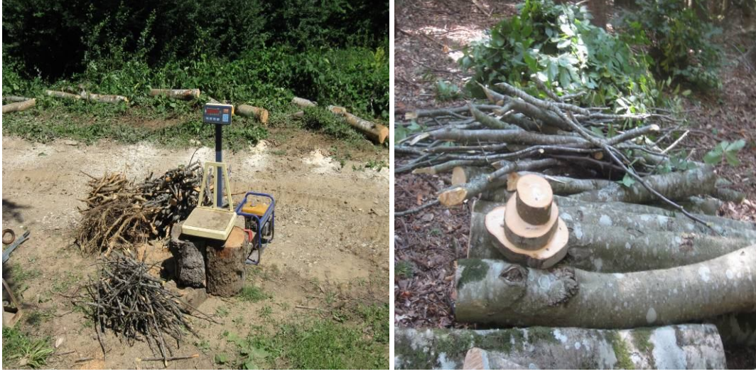
Şekil 5. Dal, yaprak ve gövde olarak ayrılan örnek ağaçların seksiyonlara ayrılan gövdelerinin yaş ağırlıklarının arazide belirlenmesi (Orijinal, 2010).
