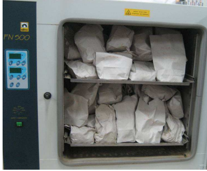
Şekil 2.23: Araziden Alınmış Organik Madde Örneklerinin Kurutma Fırınında Kurutulması
