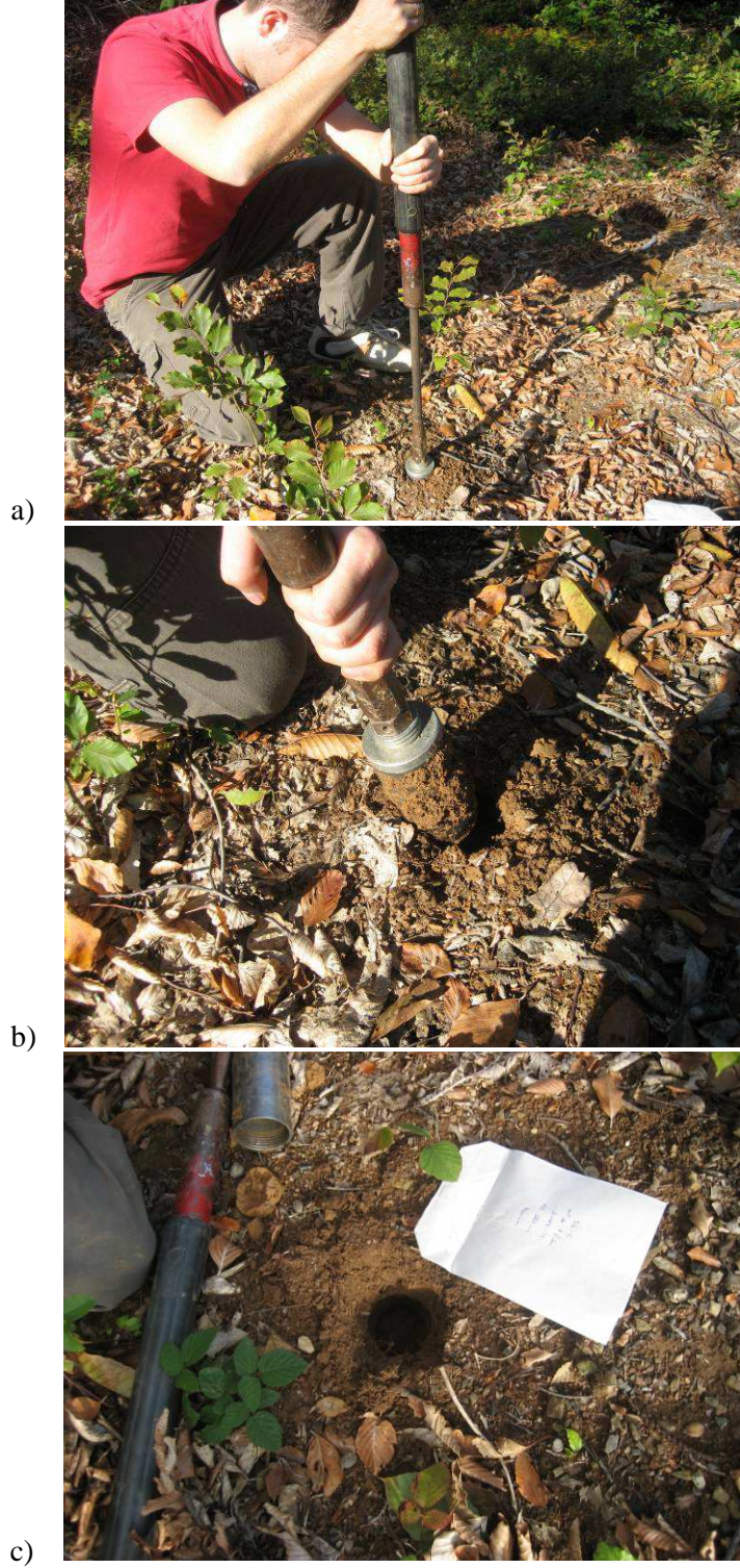
Şekil 2.24: a,b,c) Deneme Alanlarından Toprak Örneklerinin Alınması
