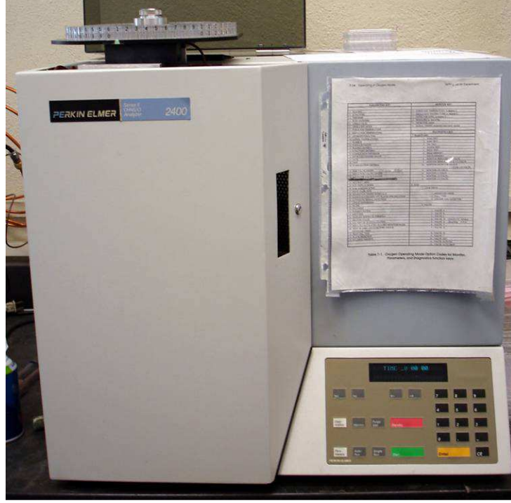
Şekil 2.19: Karbon (C) ve Azot (N) Tayini İçin Kullanılan C-N Analiz Makinesi
