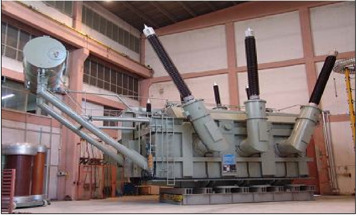
Şekil 2.17: 250 MVA'lık yağ soğutmalı güç transformatörü (İlkkahraman,2008)
