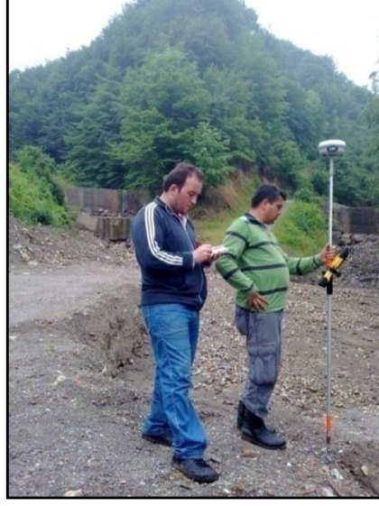
Şekil 3.14: Kaynaşlı deresinde enkesit alınması
