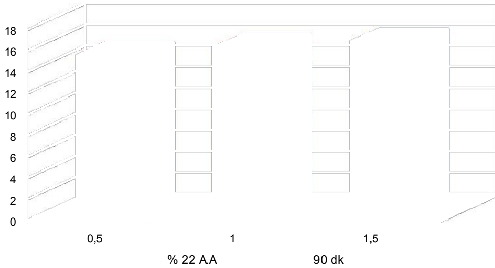
Şekil 5.4: Sodyum Borhidrür Oranının Parlaklık Üzerine Etkisi (Aktif Alkali %22, Pişirme sıcaklığı 160 °C, Pişirme süresi 90dk sabit tutulmuştur)
