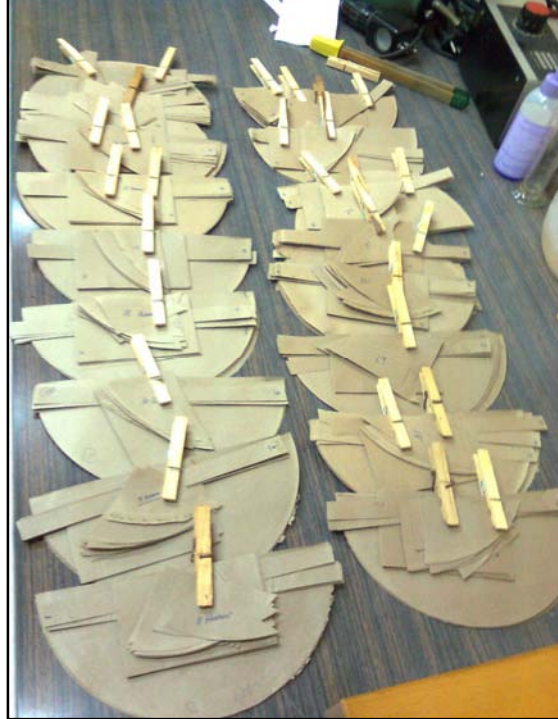
Şekil 3.12: Kağıt numunelerini testlere hazırlanması (İstanbul Üniversitesi; Kağıt Testleri Lab.)
