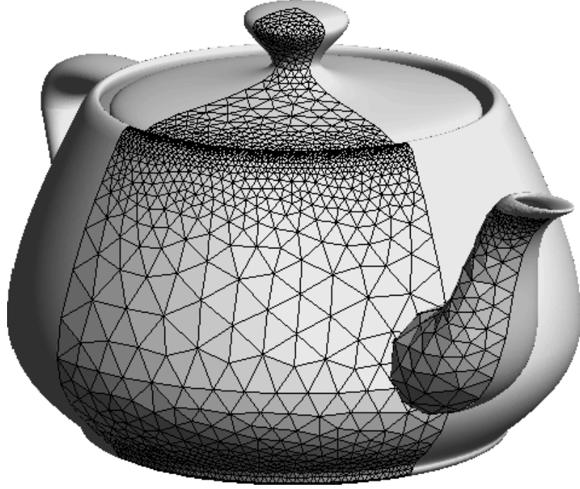
Şekil 2.3: Üçgenlerle matematiksel olarak modellenmiş örnek nesne (Anon, 10 Eylül 2010)
