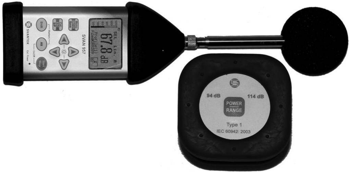
Şekil 2.11. Svan 957 model gürültü ölçüm cihazı ve SV30 model kalibratör.
