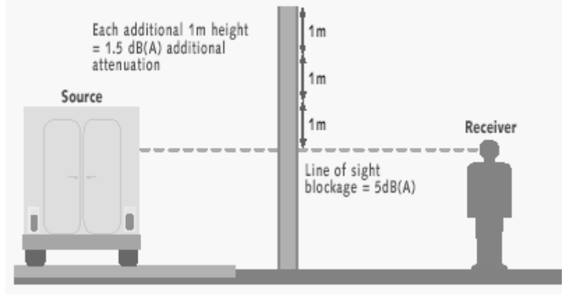
Şekil 1.11. Perdenin yükseltilmesiyle gürültü miktarının azaltılması (Anonim 2011b).
