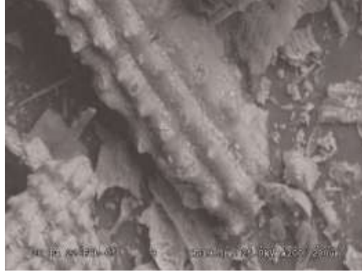
Şekil 2.2: (Bangladesh)PK Külünün mikro yapısı(SEM) (Farooque ve diğ., 2009).
