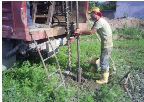
Şekil 4.2: Arazide zeminden numunenin çıkartılması
