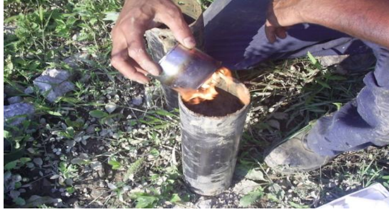
Őekil 4.3: Arazide zeminden ıkarılan numunenin parafınle kaplanması
