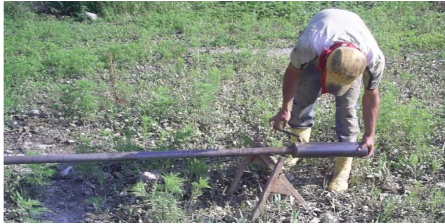
Őekil 4.4: Arazide zeminden ıkarılan silindirik tpn bařlıktan ayrılması
