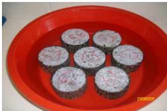
Şekil 5.26: 3 mol NaCl ile asfalt beton numunelerin aynı ortama konulması
