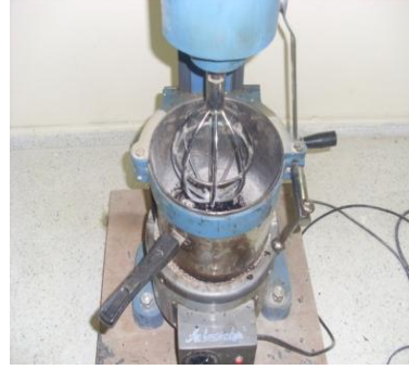
Şekil 5.13: Hazırlanan agrega ve bitümün Karıştırılması
