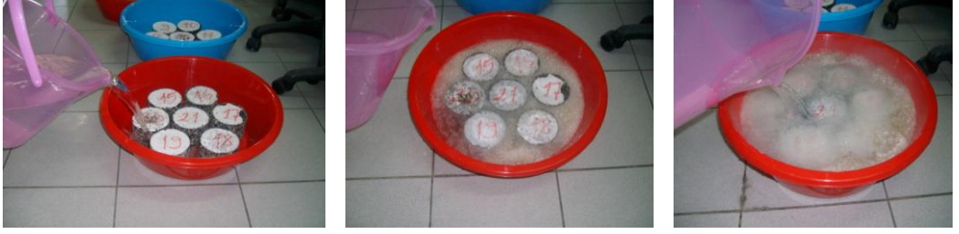
Şekil 5.20: Asfalt beton numunelerin üzerine 1 mol HCl çözeltisinin dökülmesi ve reaksiyonu
