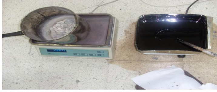
Şekil 5.11: Karışım için hazırlanmış agrega ve bitüm
