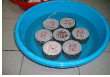
Şekil 5.27: 4 mol NaCl ile asfalt beton numunelerin aynı ortama konulması
