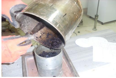
Şekil 5.14: Elde edilen karışımın marshall kalıplarına yerleştirilmesi
