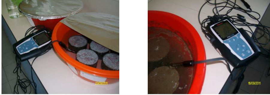
Şekil 5.31: pH ölçümlerinin yapılması
