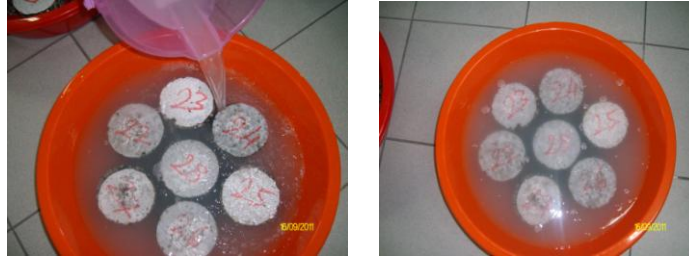
Şekil 5.28: Asfalt beton numuneler üzerine 1 mol CaCl_2 dökülmesi
