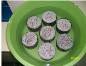
Şekil 5.29: Saf su içerisindeki asfalt beton numuneler.
