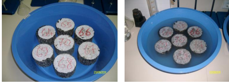
Şekil 5.24: Asfalt beton numuneler üzerine 1 mol NaOH çözeltisinin dökülmesi
