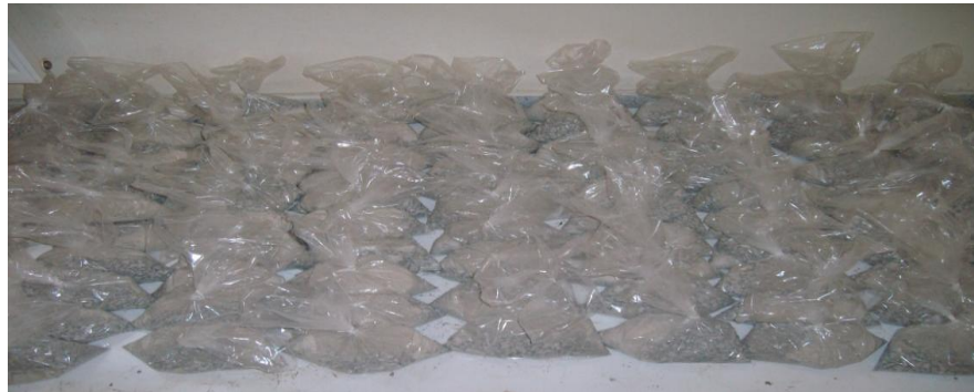
Şekil 5.5: Sıcak karışım için hazırlanmış olan agreganın karışımları
