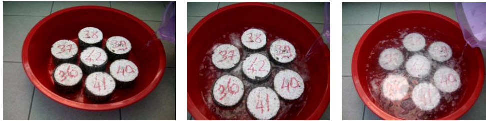
Şekil 5.23: Asfalt beton numuneler üzerine 0,5 mol \text{H}_2\text{SO}_4 çözeltisinin dökülmesi ve reaksiyonu
