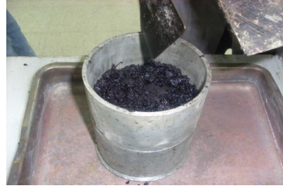
Şekil 5.14: Elde edilen karışımın marshall kalıplarına yerleştirilmesi
