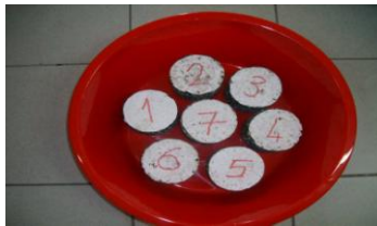
Şekil 5.25: 1 mol NaCl ile asfalt beton numunelerin aynı ortama konulması
