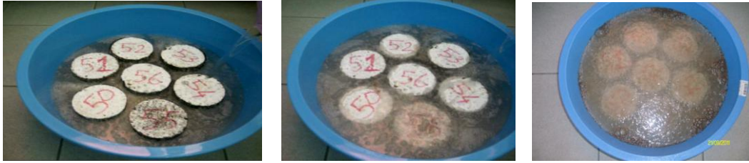
Şekil 5.22: Asfalt beton numuneler üzerine 1 mol \text{HNO}_3 çözeltisinin dökülmesi ve reaksiyonu
