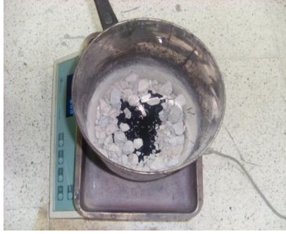
Şekil 5.12: Bitüm ilave edilmiş agrega
