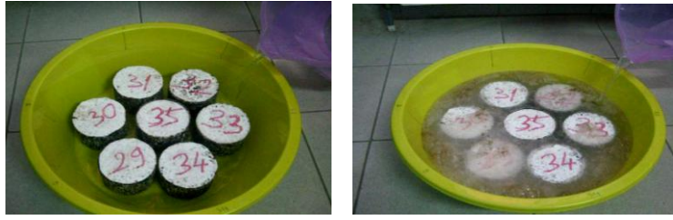
Şekil 5.21: Asfalt beton numunelerin üzerine 2 mol HCl çözeltisinin dökülmesi ve reaksiyonu
