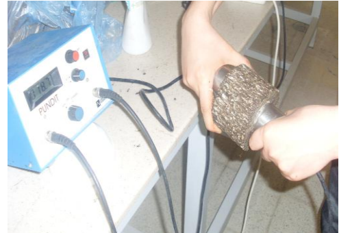
Şekil 5.33: Ultrases ölçümünün yapılması
