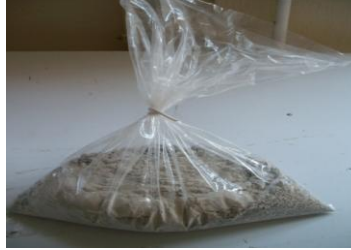
Şekil 5.4: Ön denemelerle belirlenen ağırlığa göre hazırlanmış agreganın örneği
