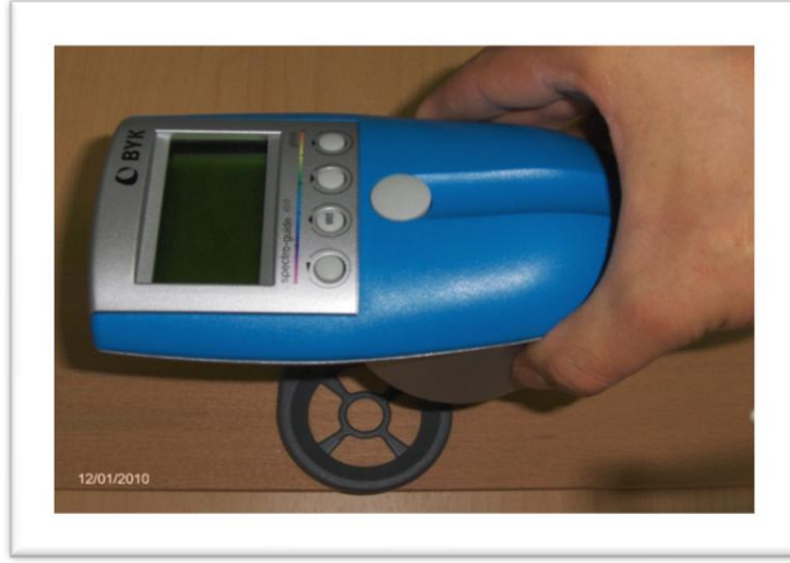
Şekil 2.4. BYK – GARDNER SPEKTRO-GUİDE 45/0 renk ve parlaklık ölçer cihazı.
