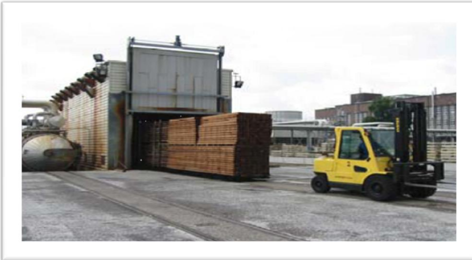
Şekil 1.8. Denkleştirme aşaması için kullanılan endüstriyel fırın (Boonstra 2008).
