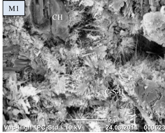
Şekil 4.7. PÇ (referans) çimento hamurunun SEM resmi
