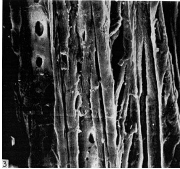
Şekil 2.5. Üç yüzyıl Norveç’te Kuzey Avrupa’nın soğuk iklimine maruz kalmış çamın orta lamelinin ortadan kalktığını gösteren ve traheidleri arasındaki aşınma örneği (Bucur 2011)
