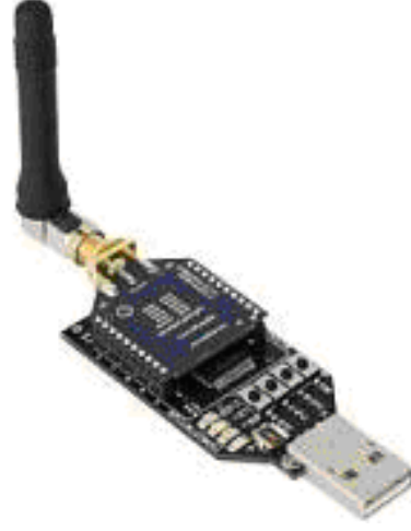
Şekil 2.13. Alıcı ve gönderici ünitesi [26]
