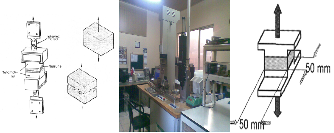
Şekil 2.9. Levha yüzeyine dik yönde çekme direnci tayini TS-EN 622-5 (2008).
