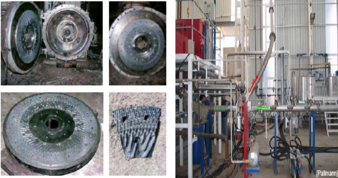
Şekil 1.27. Defibratör segment yapısı (Metso). Şekil 1.28. Defibratör çıkışı blow line (Pallmann ve wood academy 2008).
