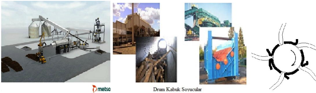
Şekil 1.17. Tambur (debarker) kabuk soyma (Metso panelboard 2008) Karşı 5 bıçaklı kabuk soyucu.
