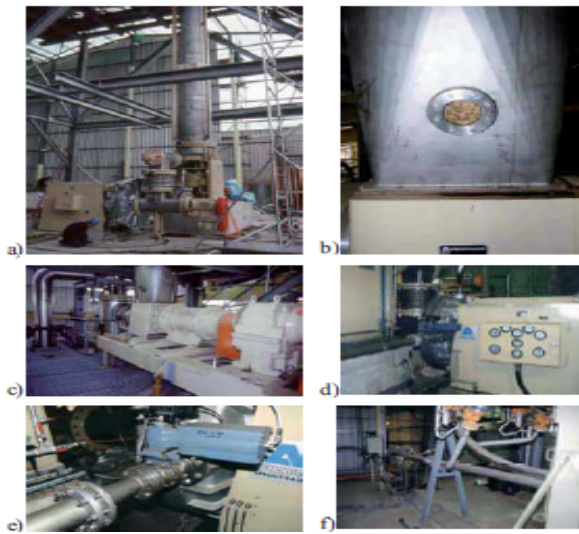
Şekil 1.24. Rafiner yapısı ve genel görünümü (IWA, wood based panels 2008).
