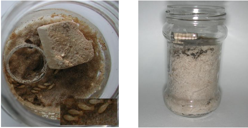
Şekil 2.8. Test kaplarının hazırlanması ve termitlerin yerleştirilmesi.
