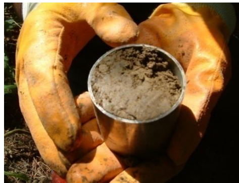
Şekil 2.25. Uludağ Milli Parkı’nda toprak örnekleme silindirleri ile toprak örnekleri alınması.
