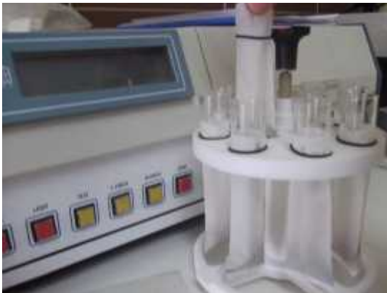
ekil 2.29. Fibrebaglerin yerleştirilmesi.
