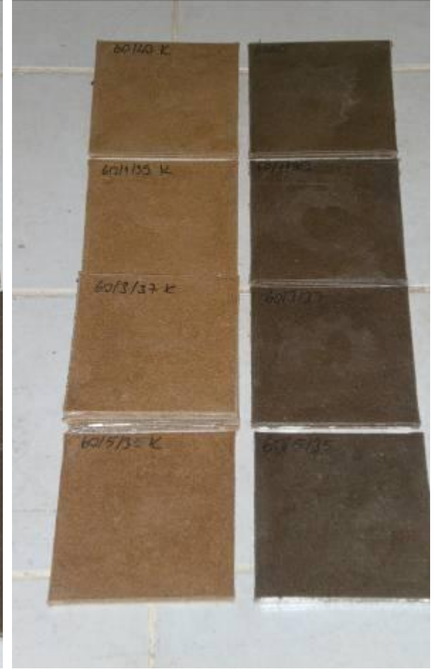
Şekil 2.9. % 60 Odun unu içeren OPK örnekleri.
