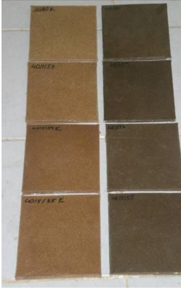
Şekil 2.7. % 40 Odun unu içeren OPK örnekleri.
