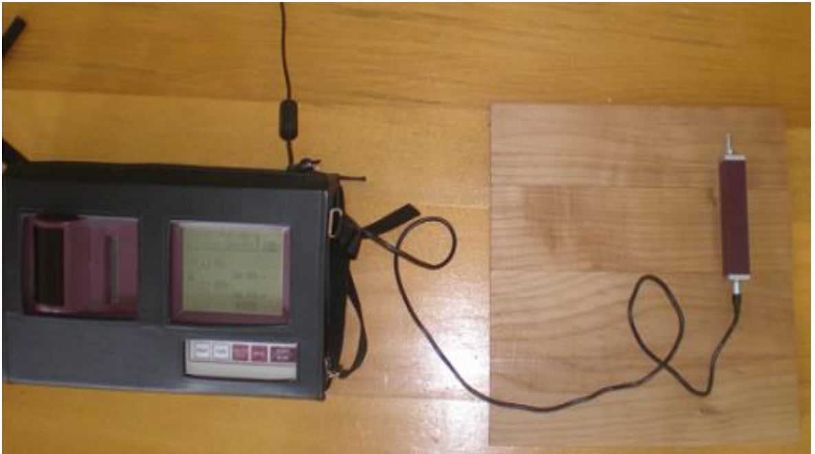
Şekil 2.16. Mitutoyo Surftest SJ-301 ile yüzey pürüzlülüğü ölçülmesi (Aytin 2012).
