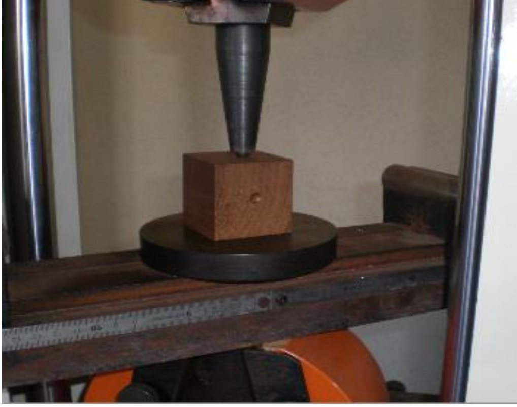
Şekil 2.25. Janka sertlik deneyi (Aytin 2012).
