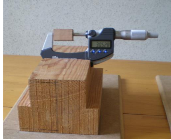
Şekil 2.12. Boyuna yönde uzunluğun ölçülmesi (Aytin 2012).
