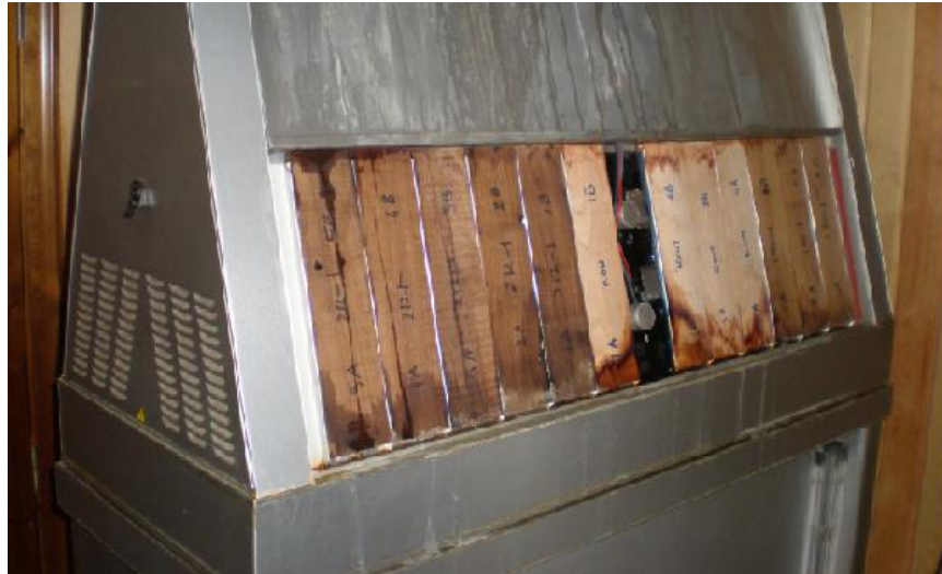
Şekil 2.10. Hızlandırılmış test cihazında örneklerin yerleşimi (Aytin 2012).
