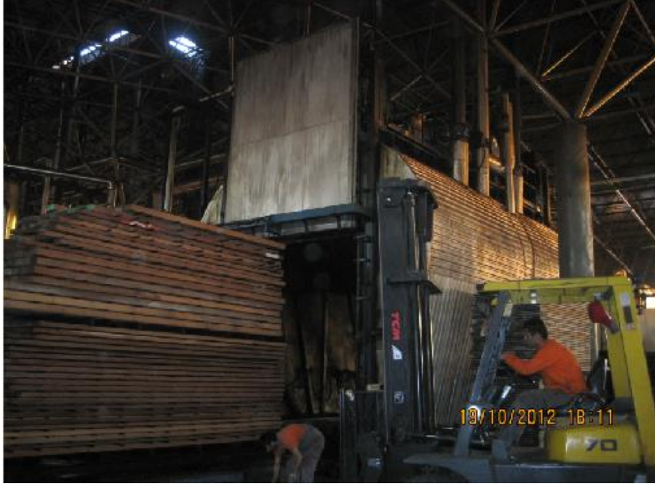
řekil 1.3. ThermoWood ynteminde fırının bořaltılması (Aytin 2012).
