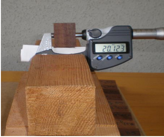
Şekil 2.11. Radyal ve teğet boyutların ölçülmesi (Aytin 2012).
