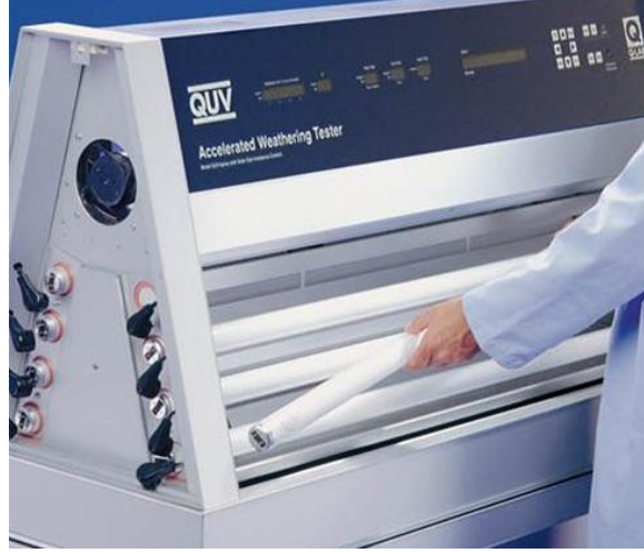
Şekil 2.7. UV-B 313 Lambaların montajı (Anonim 2012).
