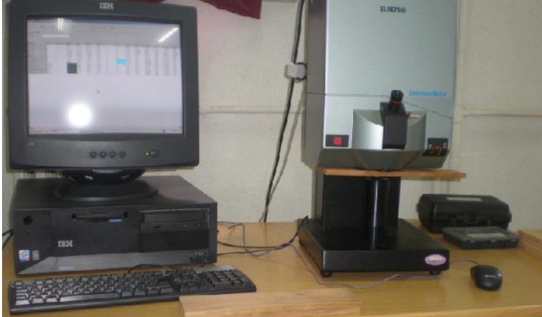
Şekil 2.18. Elrepho 71 cihazı ile renk değerlerinin belirlenmesi (Aytin 2012).
