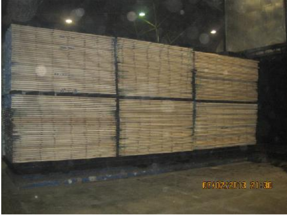
Şekil 1.2. ThermoWood yöntemi fırının doldurulması (Aytin 2012).
