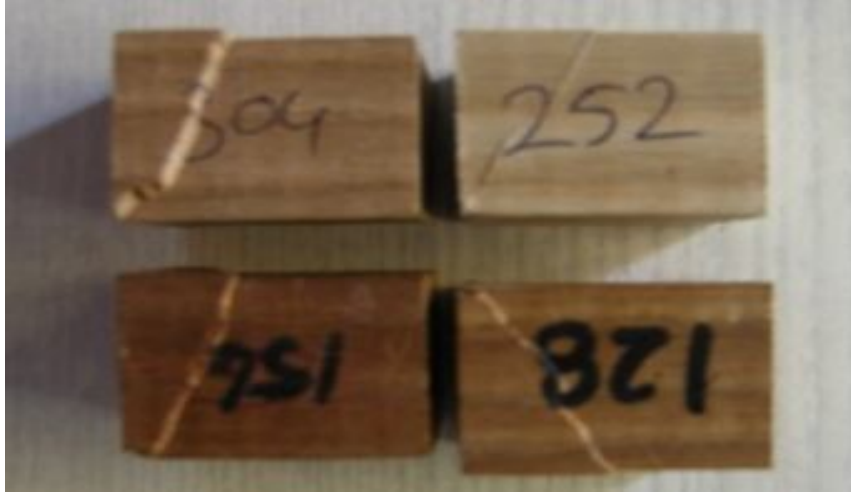
Şekil 2.12. Liflere paralel basınç direnci test örneklerinin deney sonrası kayma şekilleri.
