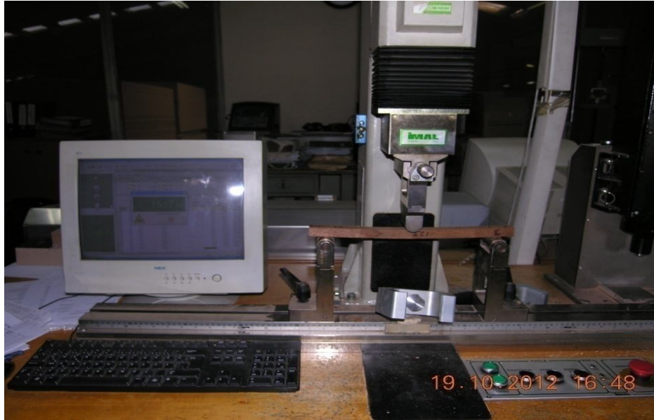
Şekil 2.14. Üniversal Test makinesinde eğilme ve elastikiyet modülü deneyi (Divapan A.Ş.).
