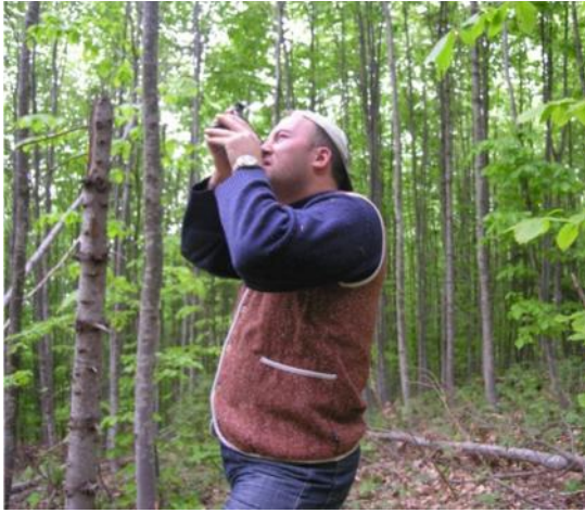
ekil 2.19. Deneme sahalarında Blume-Leiss yardımıyla boy ölçümü.
