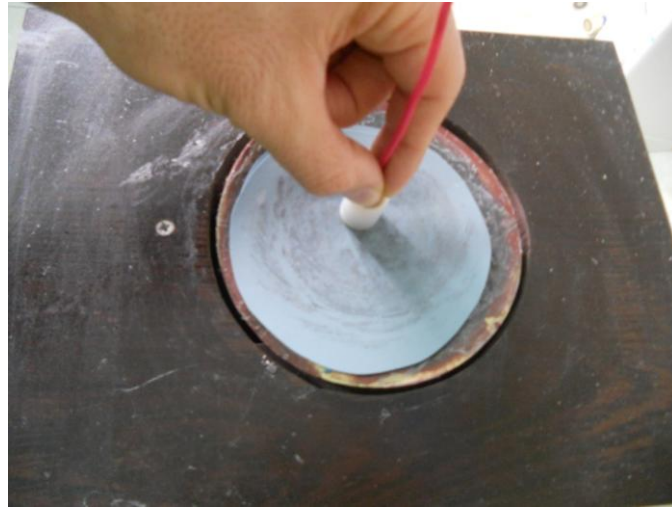
Şekil 2.3. Çalışma elektrotlarının deney öncesi yüzeylerinin zımparalanarak temizlenmesi.
